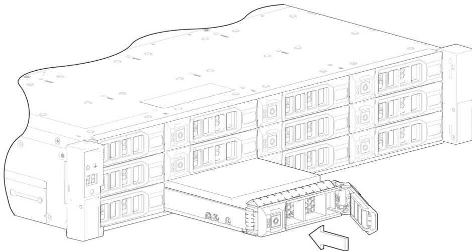
图 41: 安装 LFF 驱动器托架模块 (1/2)
