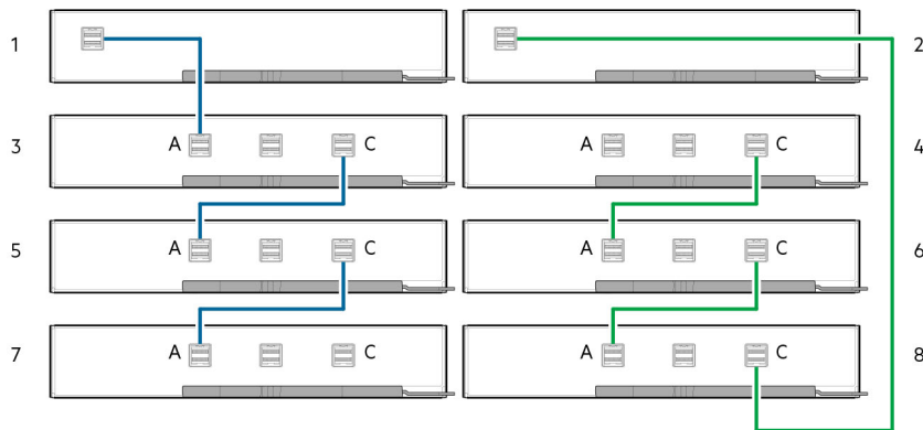
그림 14. 5U 컨트롤러 엔클로저 및 5U 확장 엔클로저 간의 역순 케이블 연결
