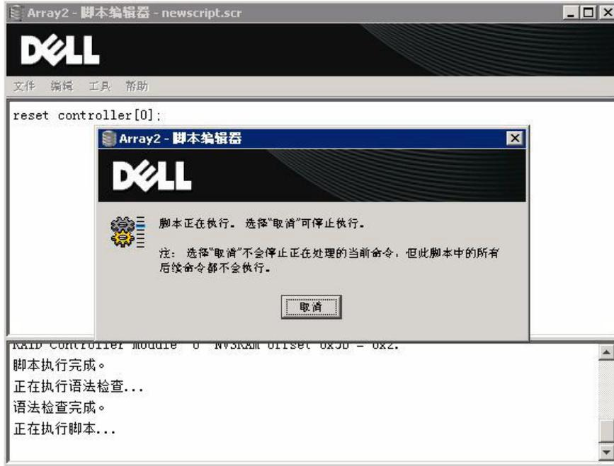
图 8: 重设主要 RAID 控制器以加载新的 NVSRAM 设置
