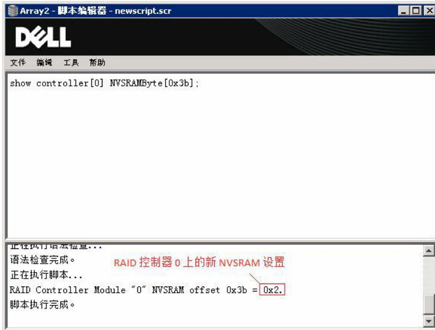
图 7: 确认新的 NVSRAM 设置
