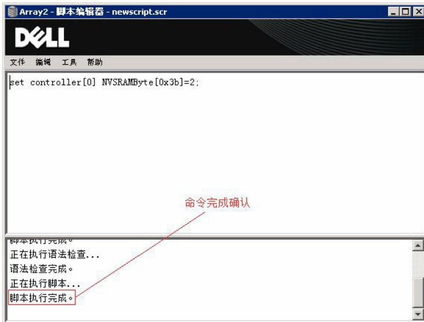
图 6: 更改主要 RAID 控制器 [0] 上的 NVSRAM 设置
