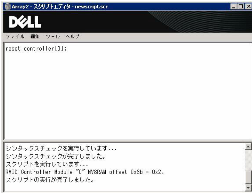
図 8. 新しい NVSRAM 設定をロードするためのプライマリ RAID コントローラのリセット
