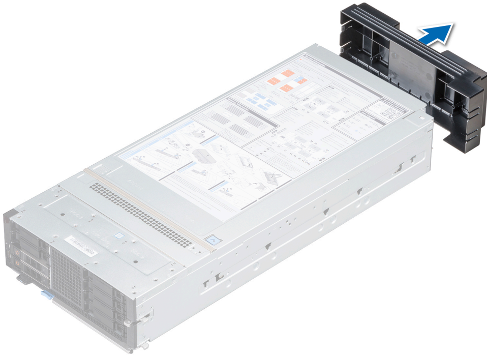
图 15: 从底座卸下 I/O 连接器护盖
