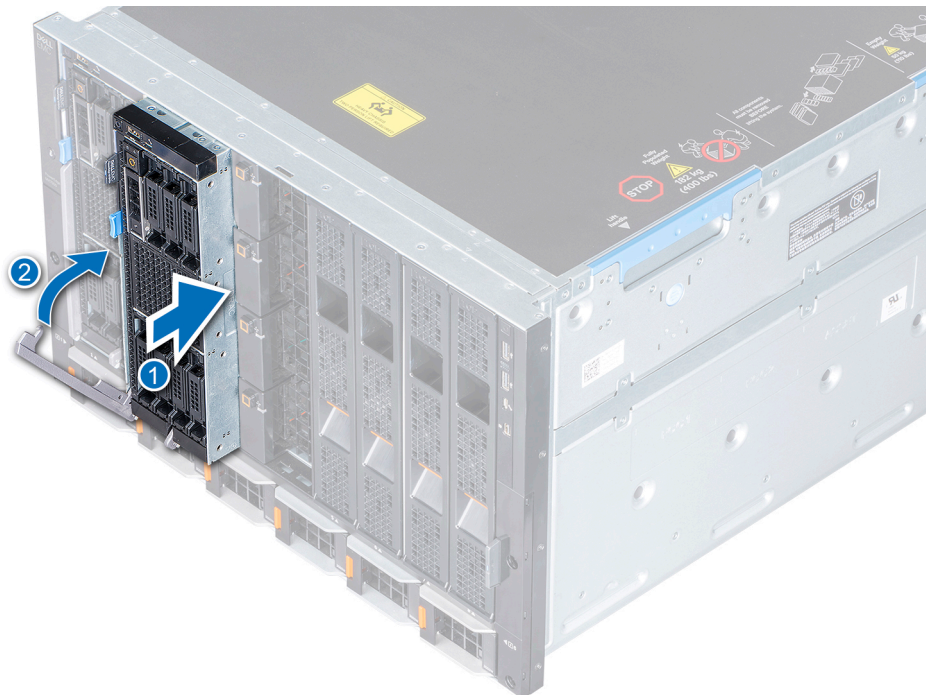
Figure 16. Installation du traîneau dans le boîtier
