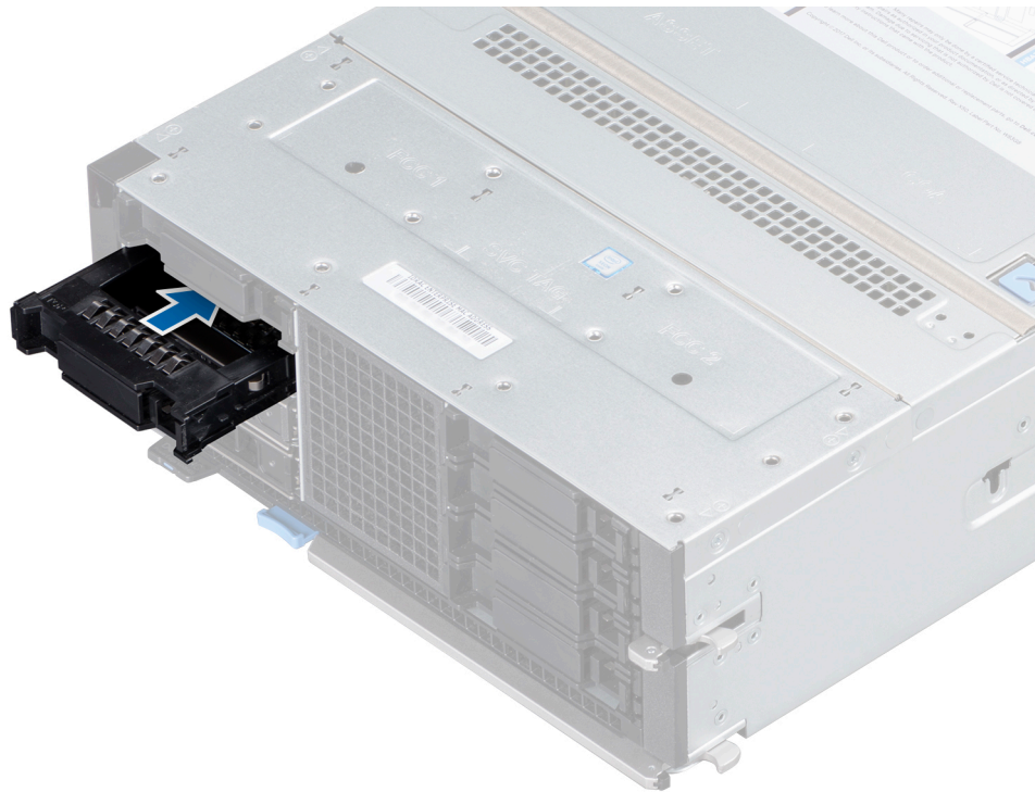
Abbildung 26. Einsetzen eines Laufwerkplatzhalters
