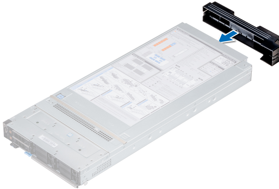
图 13: 在底座上安装 I/O 连接器护盖
