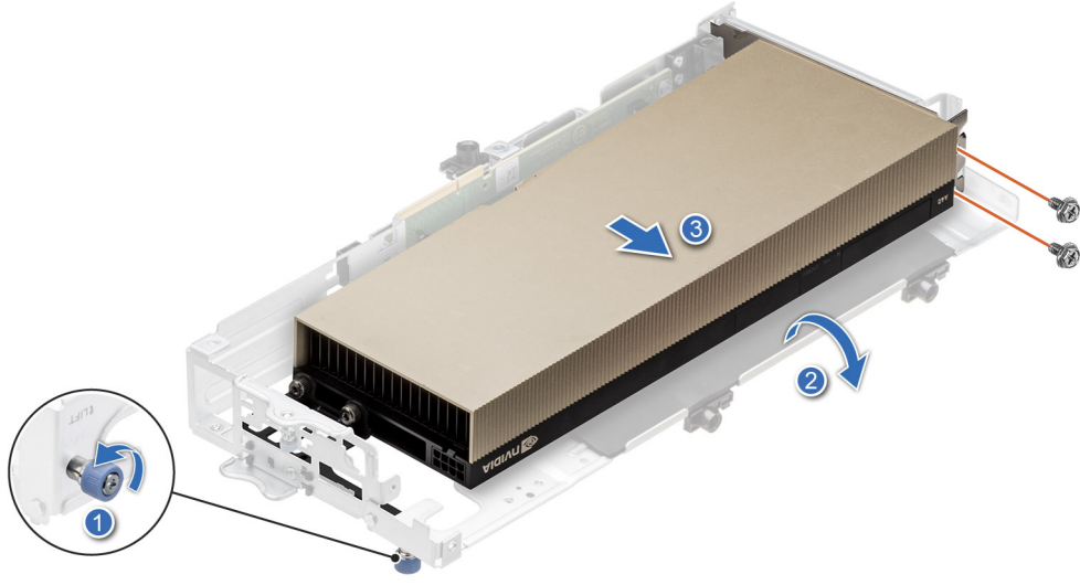
Rakam 73. Çift genişlik, tam uzunlukta bir GPU kartını Yükseltici 3A'dan çıkarma
