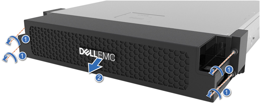
Rakam 20. Önden Erişilebilen yapılandırma için ön çerçeveyi çıkarma
