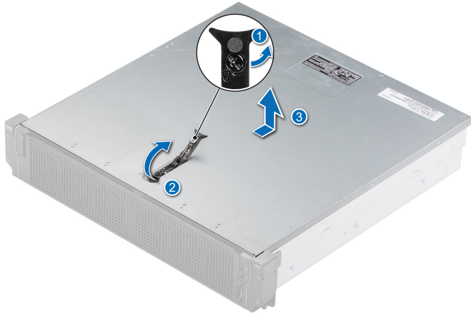
Figure 27. Retrait du capot du système pour la configuration à accès par l'arrière
