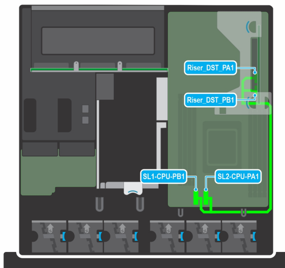
Figure 99. Connexion de la carte de montage 1A sur la carte système
