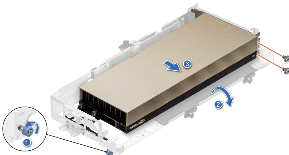
Figure 73. Retrait d'une carte de processeur graphique double largeur et pleine longueur de la carte de montage 3A
