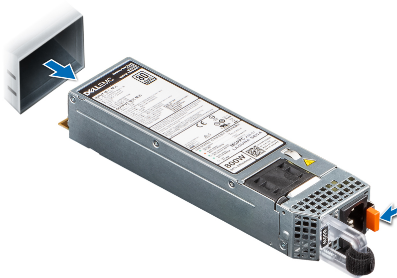
Figure 133. Retrait d'un bloc d'alimentation
