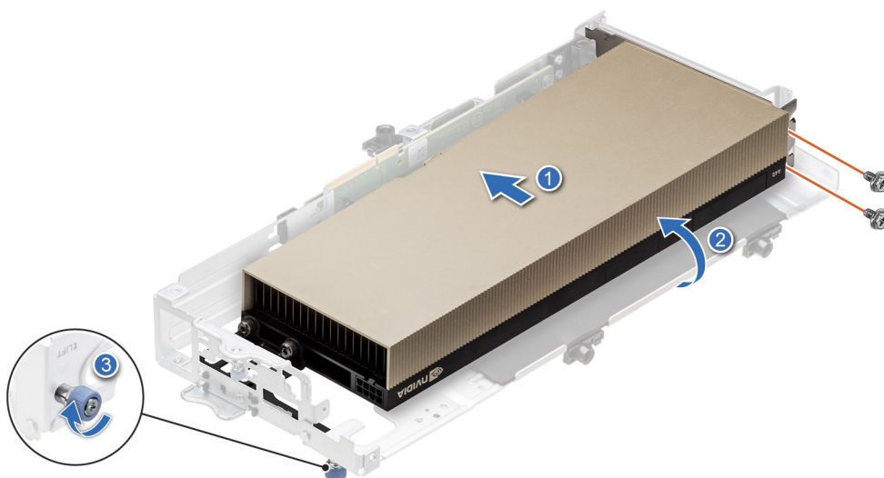
Figure 81. Installation d'une carte de processeur graphique double largeur et pleine longueur dans la carte de montage 3A
