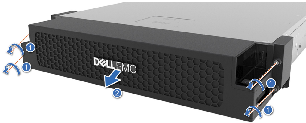
Figure 20. Retrait du panneau avant pour la configuration à accès par l'avant
