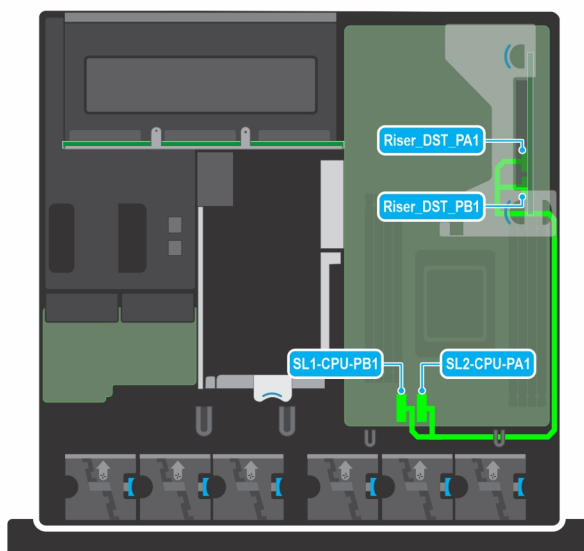
Ilustración 99. Tarjeta elevadora 1A que se conecta a la tarjeta madre
