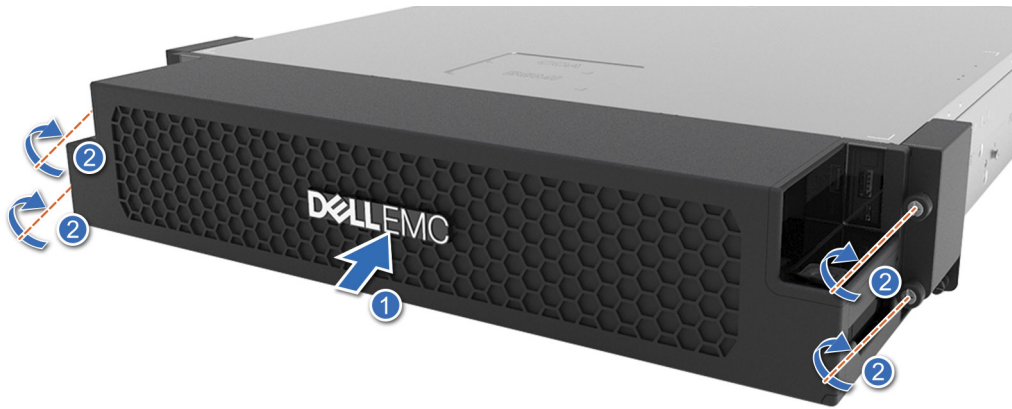
Ilustración 22. Instalación del bisel frontal para la configuración de acceso frontal
