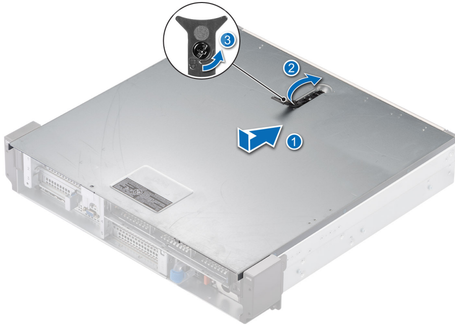
Ilustración 30. Instalación de la cubierta del sistema para la configuración de acceso frontal
