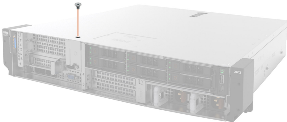
Ilustración 165. Instalación de la cubierta del sistema
