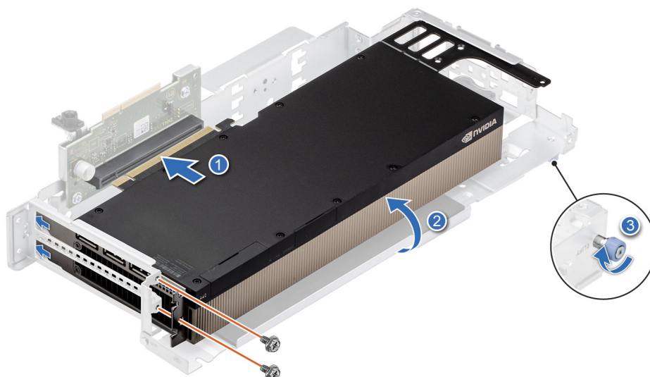
Ilustración 70. Instalación de una tarjeta GPU de longitud completa y ancho doble en la tarjeta elevadora 2A
