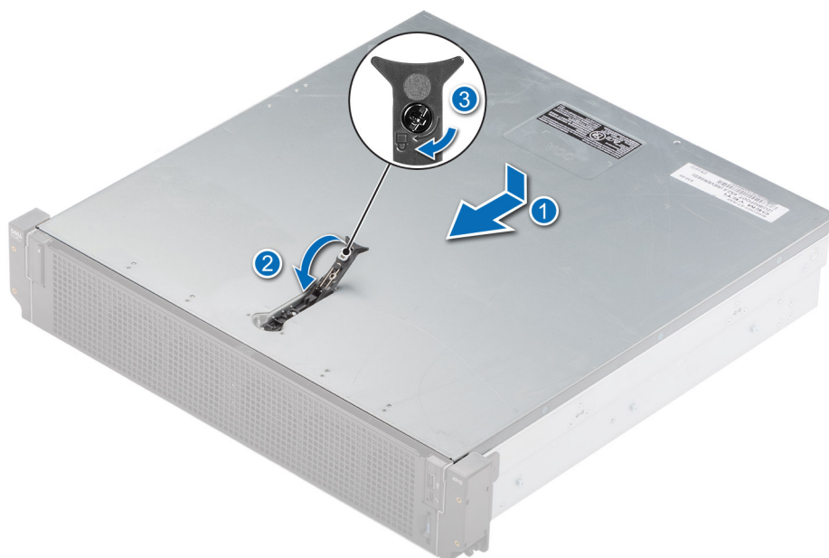
Ilustración 29. Instalación de la cubierta del sistema para la configuración de acceso posterior
