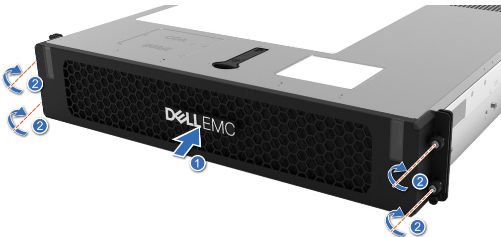
Ilustración 21. Instalación del bisel frontal para la configuración de acceso posterior
