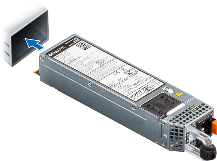
Ilustración 134. Instalación de una fuente de alimentación
