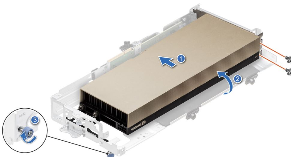
Ilustración 81. Instalación de una tarjeta GPU de longitud completa y ancho doble en la tarjeta elevadora 3A
