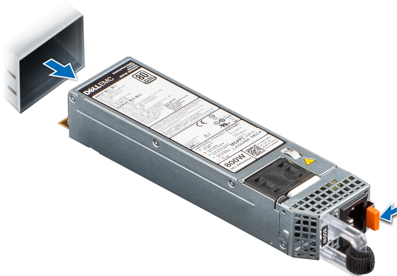
Ilustración 133. Extracción de una fuente de alimentación
