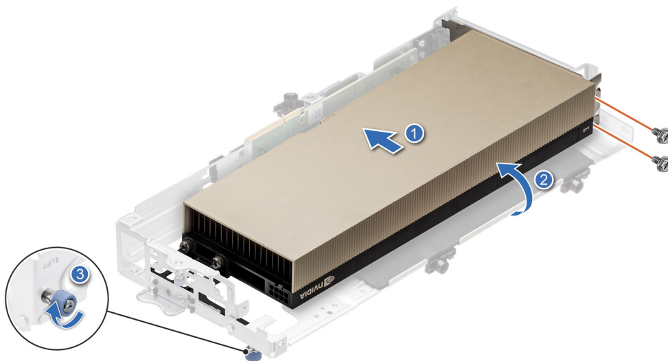
Abbildung 81. Installieren einer GPU-Karte mit doppelter Breite und voller Länge in Riser 3A
