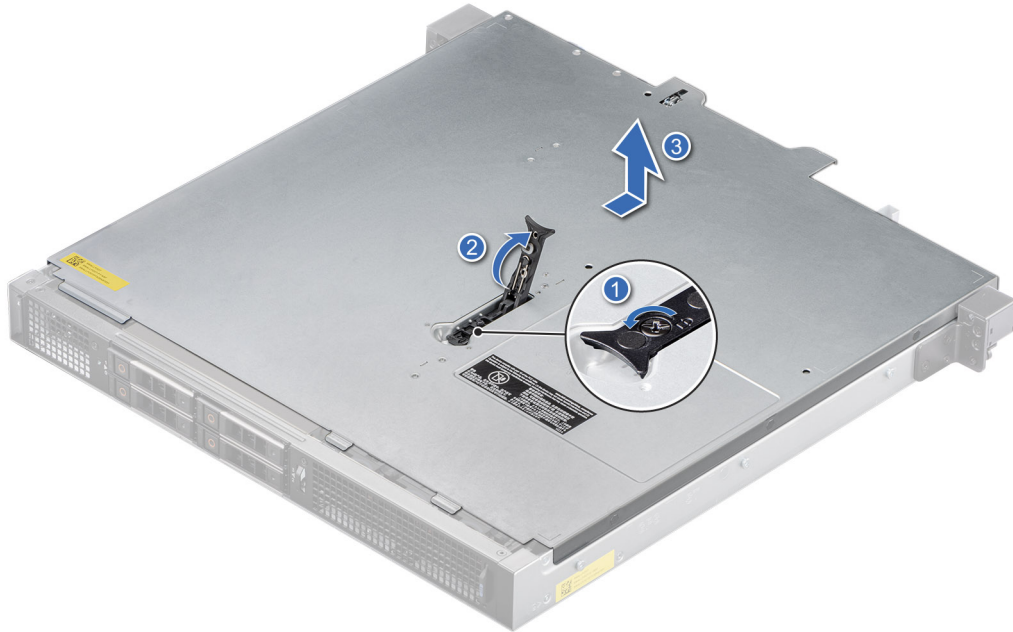
Rakam 20. Önden Erişilen yapılandırma için sistem kapağını çıkarma
