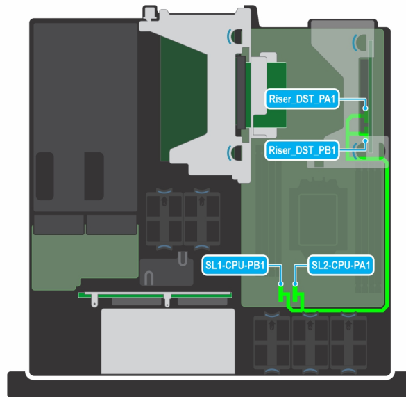
Figure 45. Connexion de la carte de montage 1A sur la carte système
