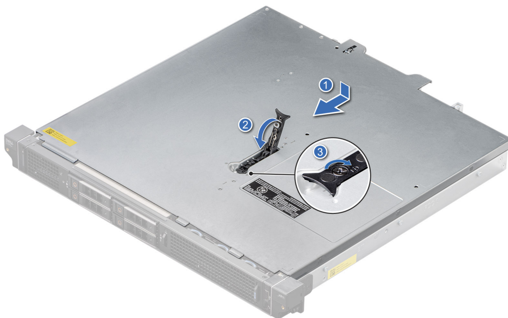
Figure 21. Installation du capot du système pour la configuration accès arrière
