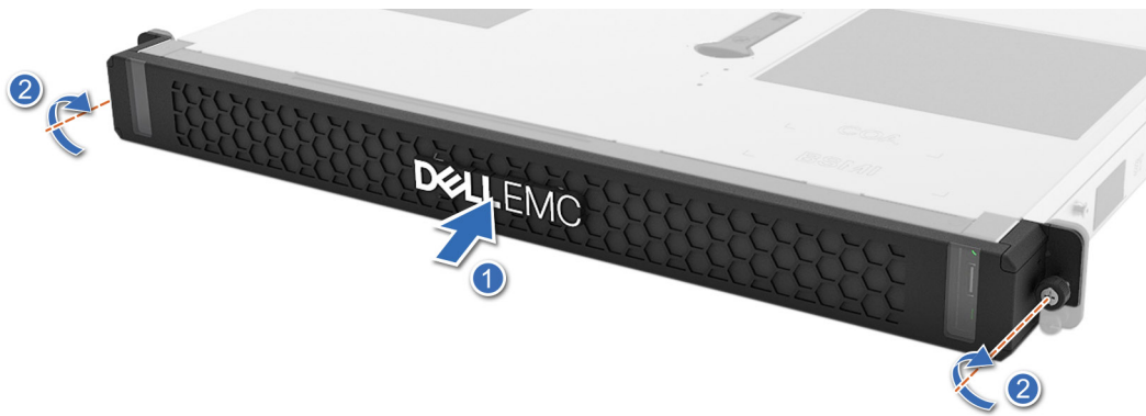
Figure 16. Installation du panneau avant pour la configuration accès arrière
