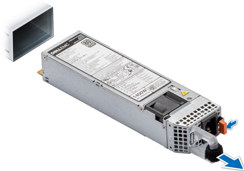
Figure 99. Retrait d'un bloc d'alimentation de la configuration accès arrière
