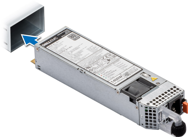
Figure 101. Installation d'un bloc d'alimentation pour la configuration à l'arrière d'accès
