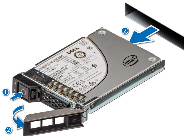
Figure 33. Retrait d'un support de disque
