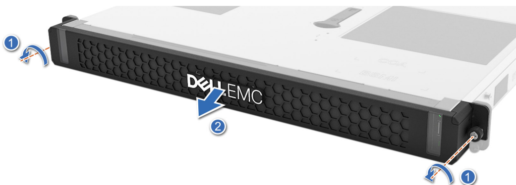
Figure 15. Retrait du panneau avant de la configuration accès arrière
