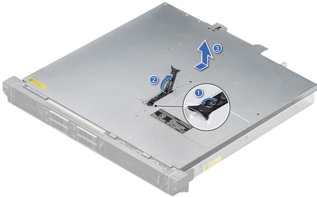
Ilustración 19. Extracción de la cubierta del sistema para la configuración de acceso posterior
