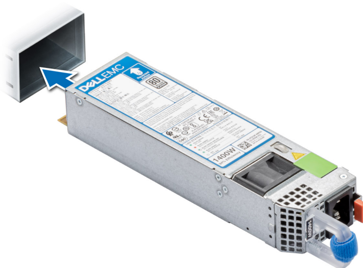
Ilustración 102. Instalación de una fuente de alimentación para la configuración de acceso frontal
