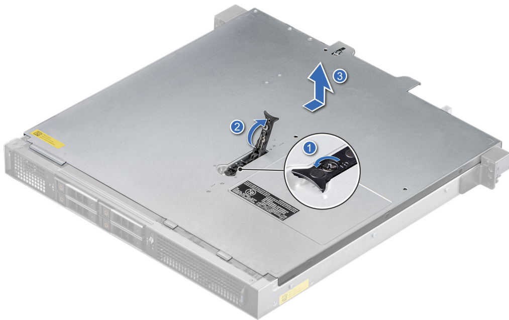
Ilustración 20. Extracción de la cubierta del sistema para la configuración de acceso frontal
