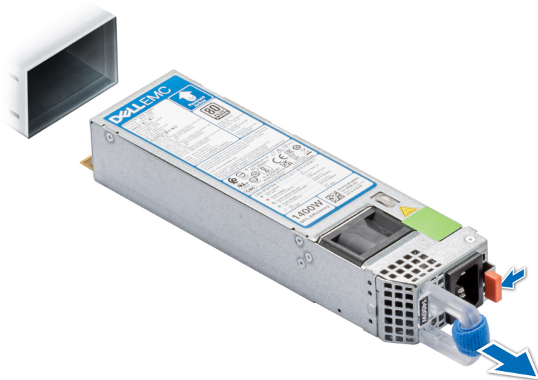
Ilustración 100. Extracción de una fuente de alimentación de la configuración de acceso frontal
