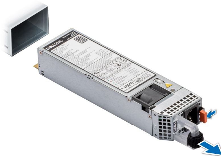
Ilustración 99. Extracción de una fuente de alimentación de la configuración de acceso posterior
