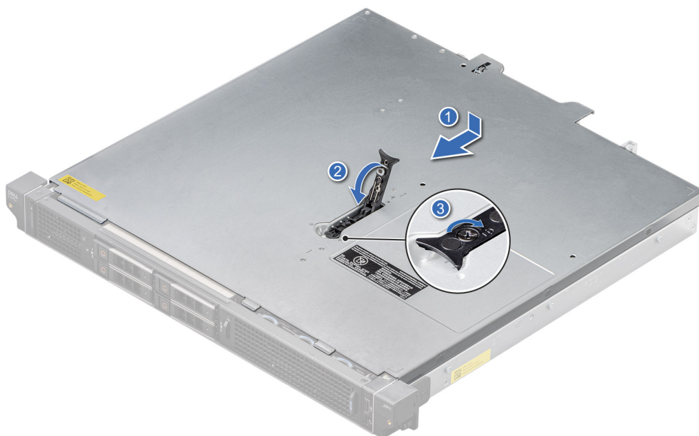
Ilustración 21. Instalación de la cubierta del sistema para la configuración de acceso posterior
