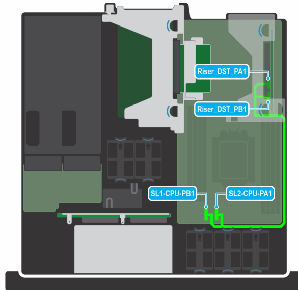
Ilustración 45. Tarjeta elevadora 1A que se conecta a la tarjeta madre
