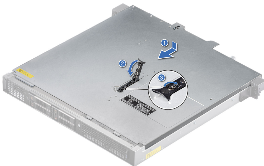
Ilustración 22. Instalación de la cubierta del sistema para la configuración de acceso frontal
