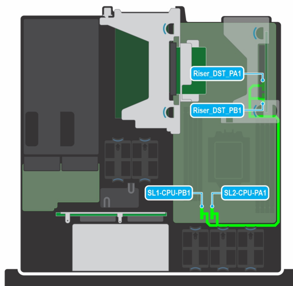
Abbildung 45. Riser 1A mit Anschluss auf der Systemplatine
