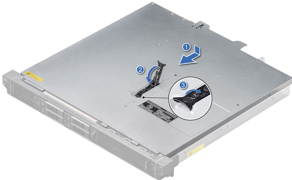
Abbildung 21. Installieren der Systemabdeckung der rückseitig zugänglichen Konfiguration
