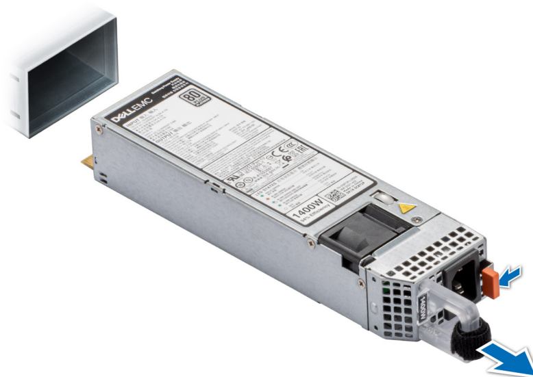
Abbildung 99. Entfernen eines Netzteils aus einer rückseitig zugänglichen Konfiguration
