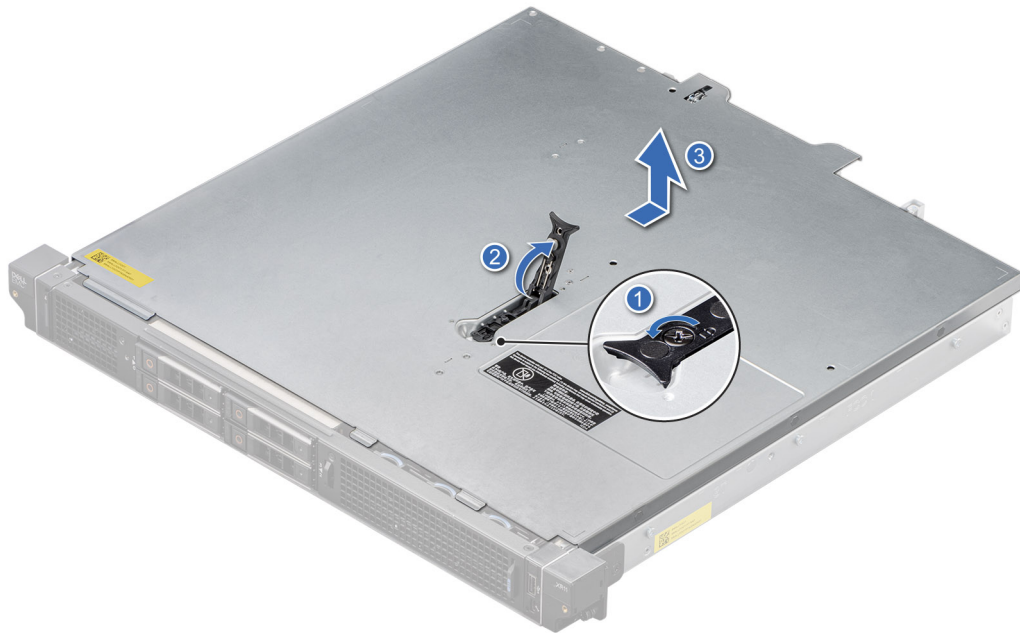
Abbildung 19. Entfernen der Systemabdeckung aus rückseitig zugänglicher Konfiguration
