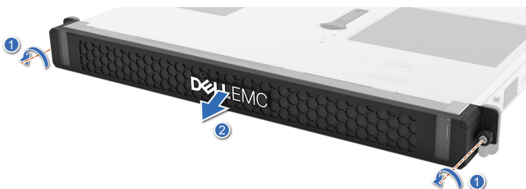
Abbildung 15. Entfernen der Frontverkleidung bei rückseitig zugänglicher Konfiguration
