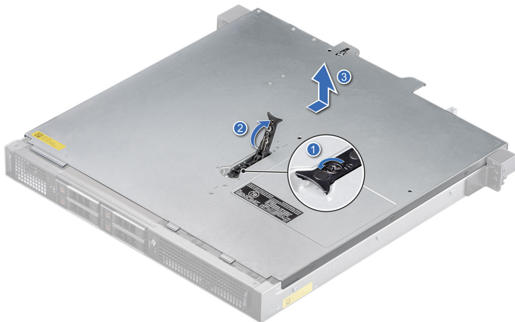
Abbildung 20. Entfernen der Systemabdeckung aus vorderseitig zugänglicher Konfiguration
