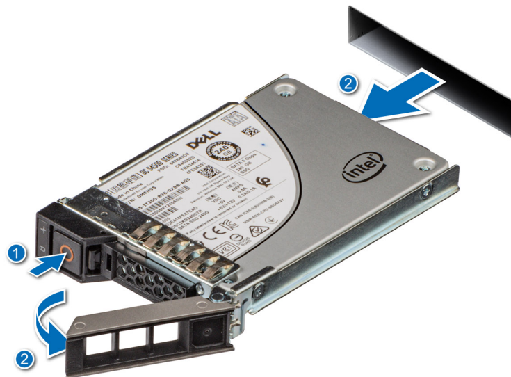
Abbildung 33. Entfernen eines Festplattenträgers
