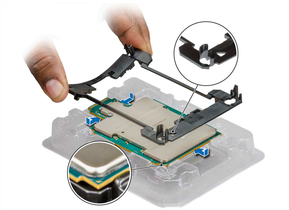
Figure 103. Installation du support de processeur
