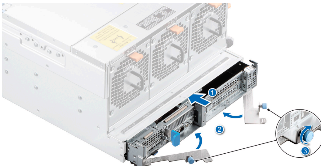
Figure 17. Installation du traîneau
