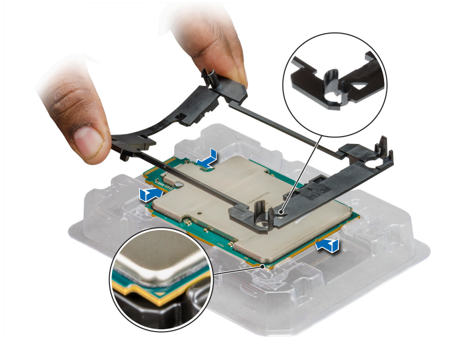
Ilustración 103. Instalación del soporte del procesador
