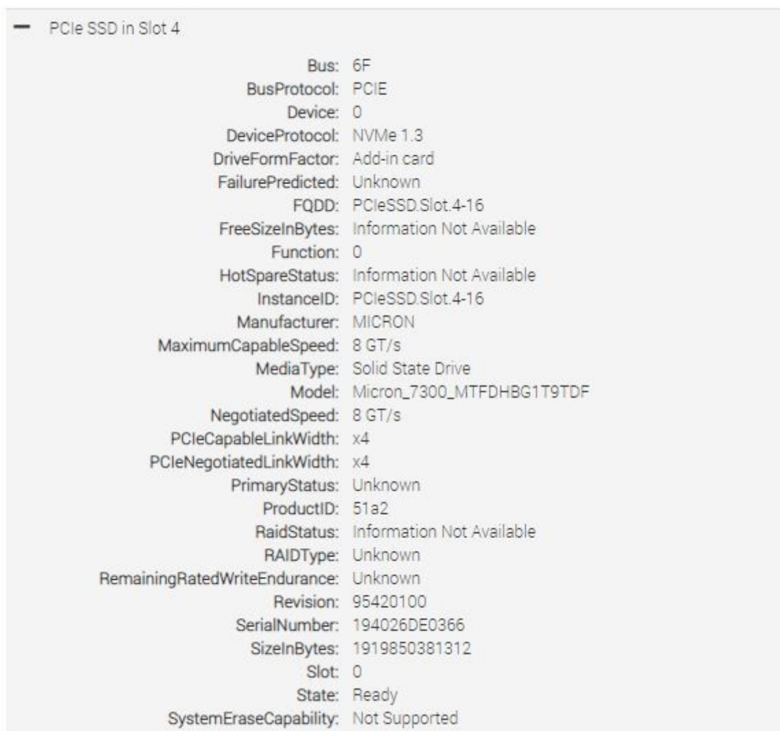
Abbildung 15. Adapter für NVMe M.2, PCIe-Speicheroptionen in der iDRAC-Bestandsliste
