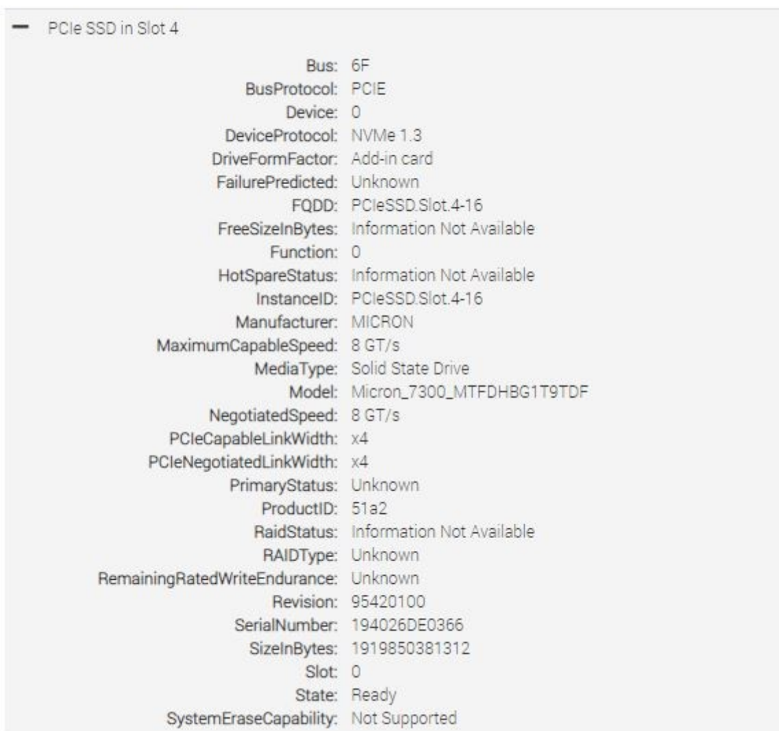
Figure 11. Options de stockage de l'adaptateur pour PCIe NVMe M.2 dans l'inventaire de l'iDRAC
