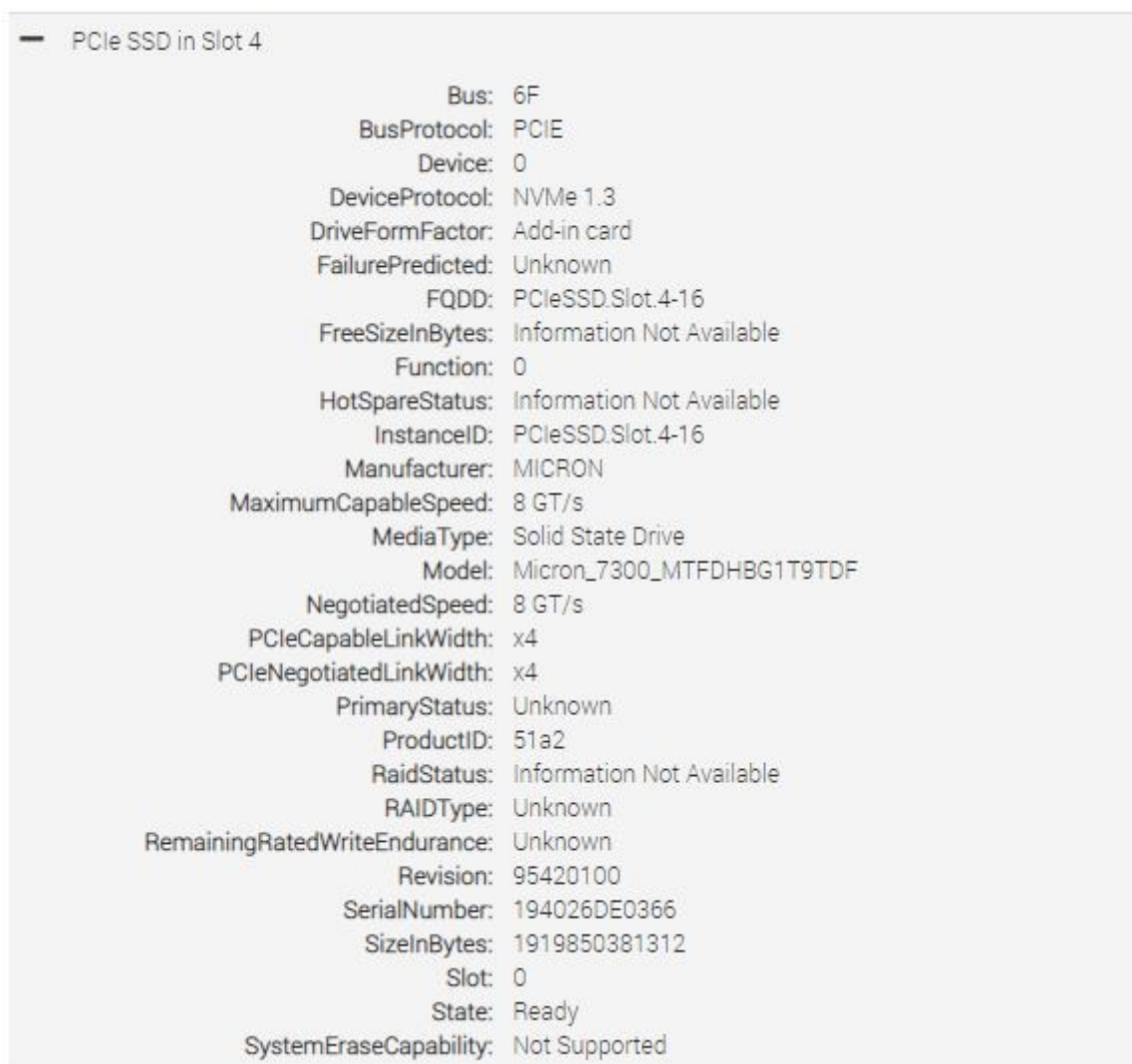
Ilustración 11. Adaptador para opciones de almacenamiento de PCIe NVMe M.2 en el inventario de iDRAC
