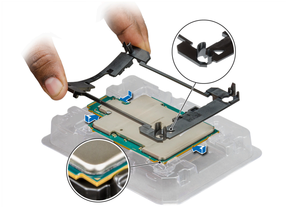
Ilustración 56. Instalación del soporte del procesador
