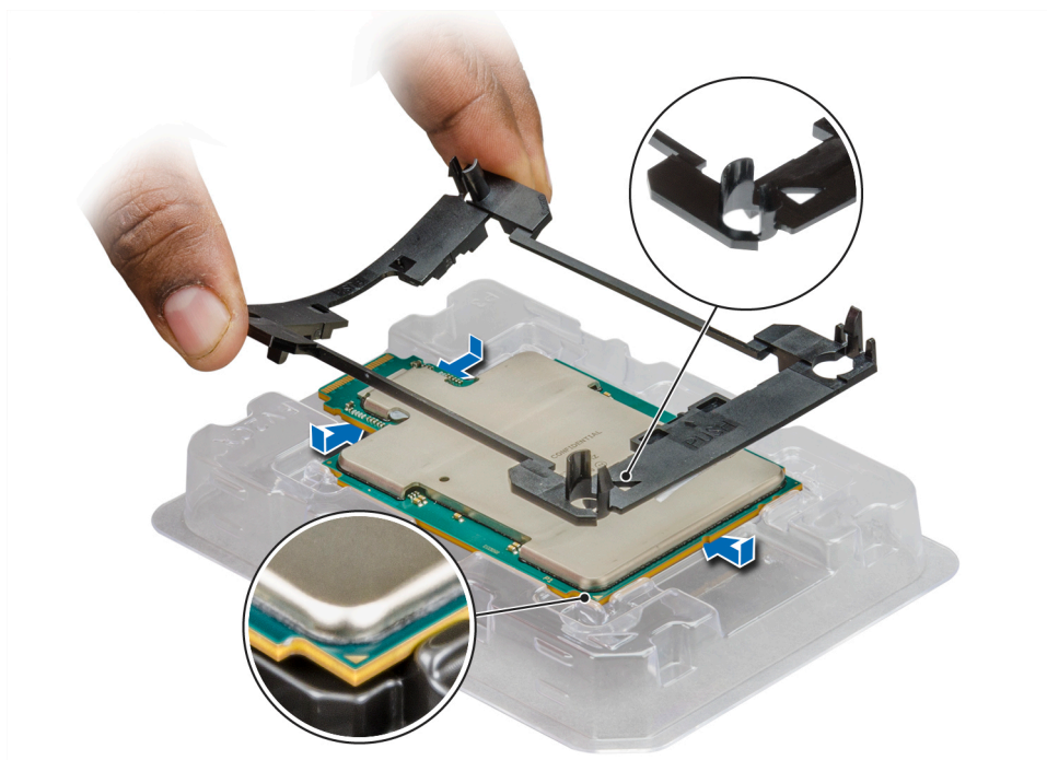
Abbildung 56. Installieren der Prozessor-Halterung
