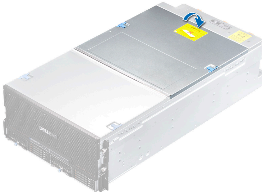
Figure 40. Installation du capot arrière du système
