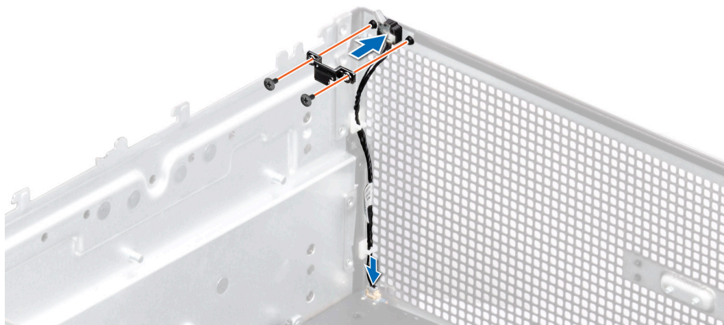
Figure 74. Installation du commutateur d'intrusion avant
