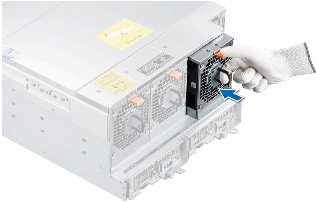
Figure 24. Installation d'un ventilateur
