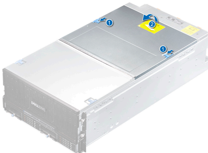
Ilustración 39. Extracción de la cubierta posterior del sistema
