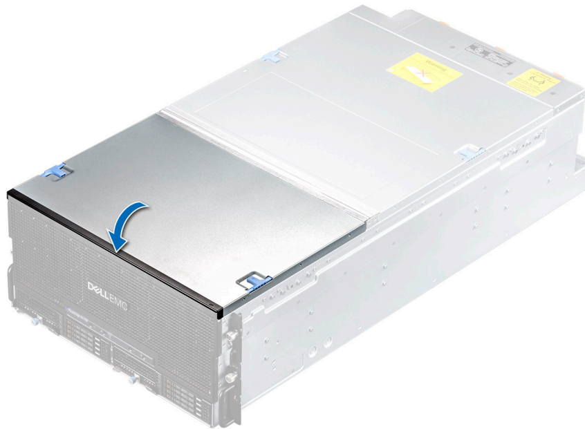
Ilustración 38. Instalación de la cubierta del sistema frontal
