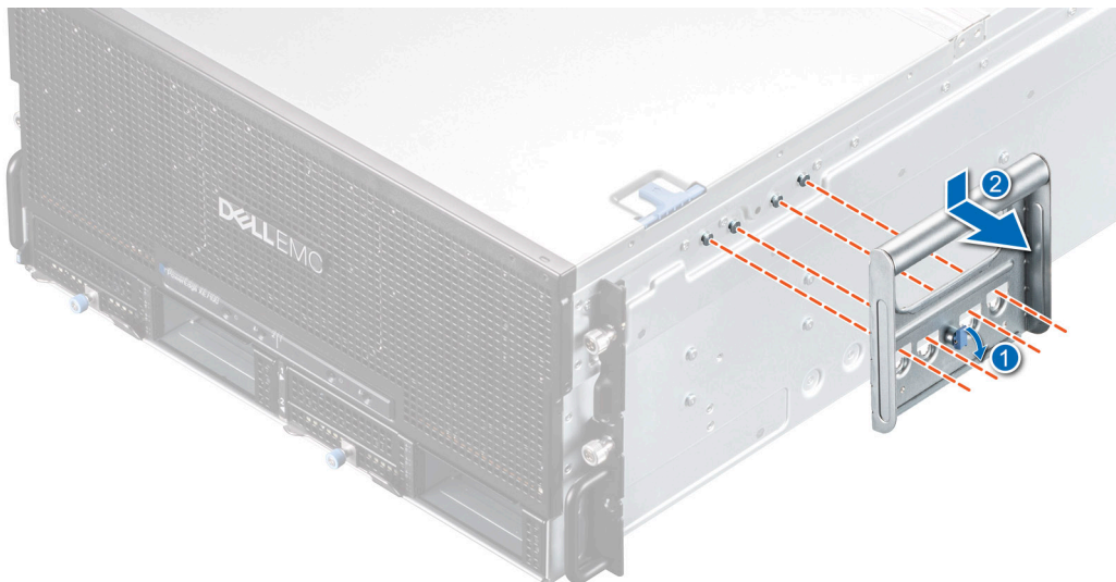
Ilustración 77. Extracción del asa
