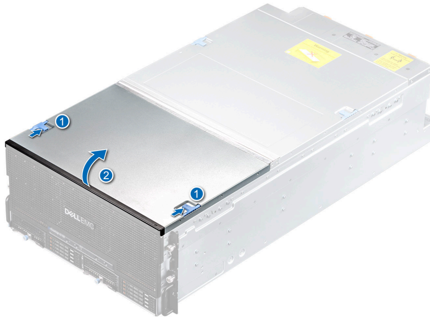
Ilustración 37. Extracción de la cubierta frontal del sistema
