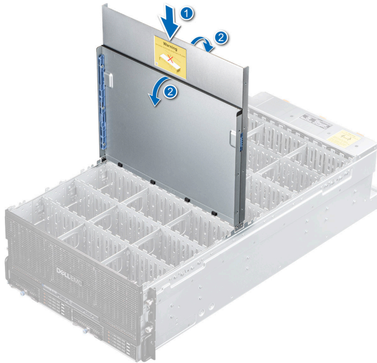
Ilustración 42. Instalación de la cubierta del sistema
