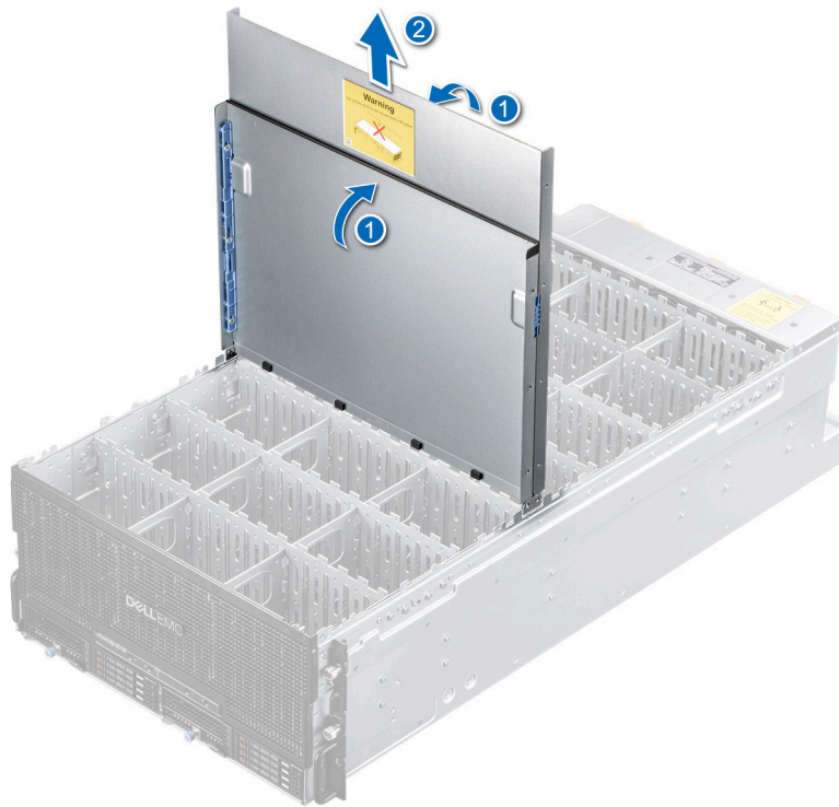
Ilustración 41. Extracción de la cubierta del sistema
