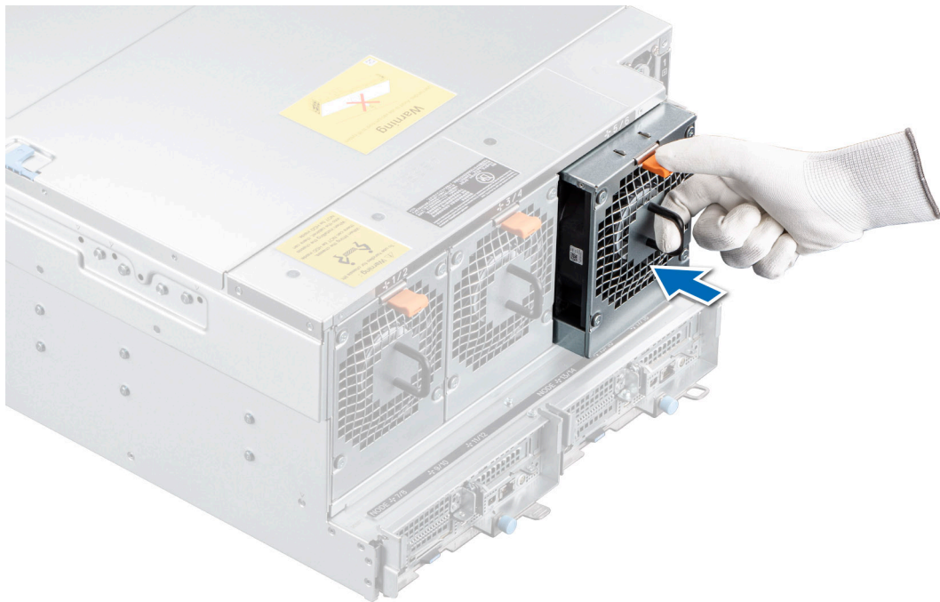
Abbildung 24. Einsetzen eines Kühlungslüfters
