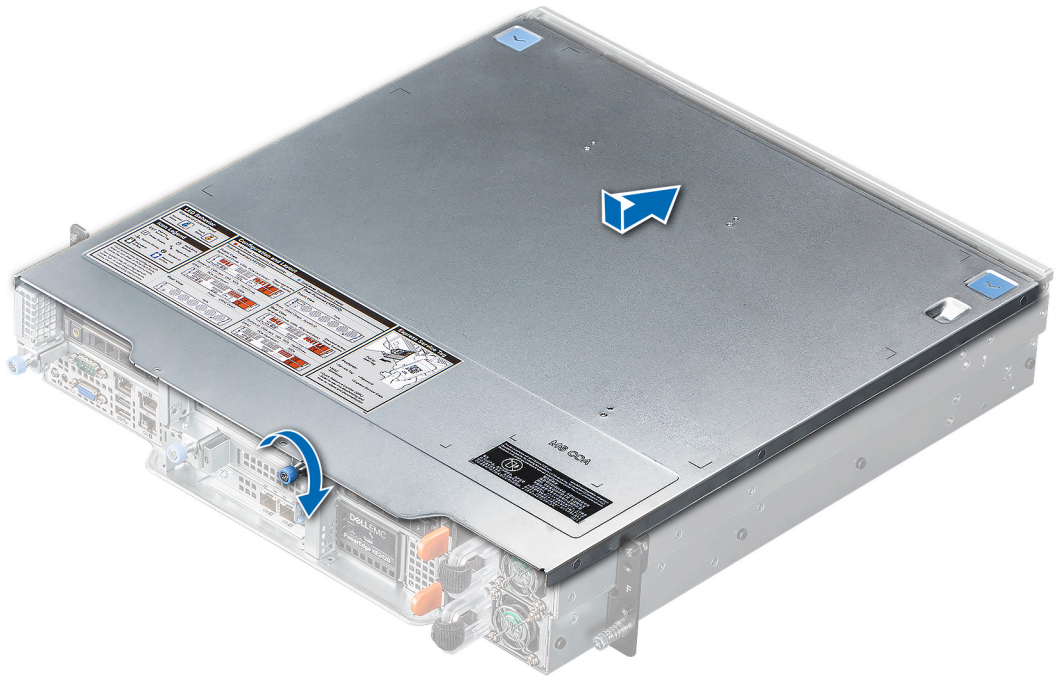
图 34: 系统护盖安装
