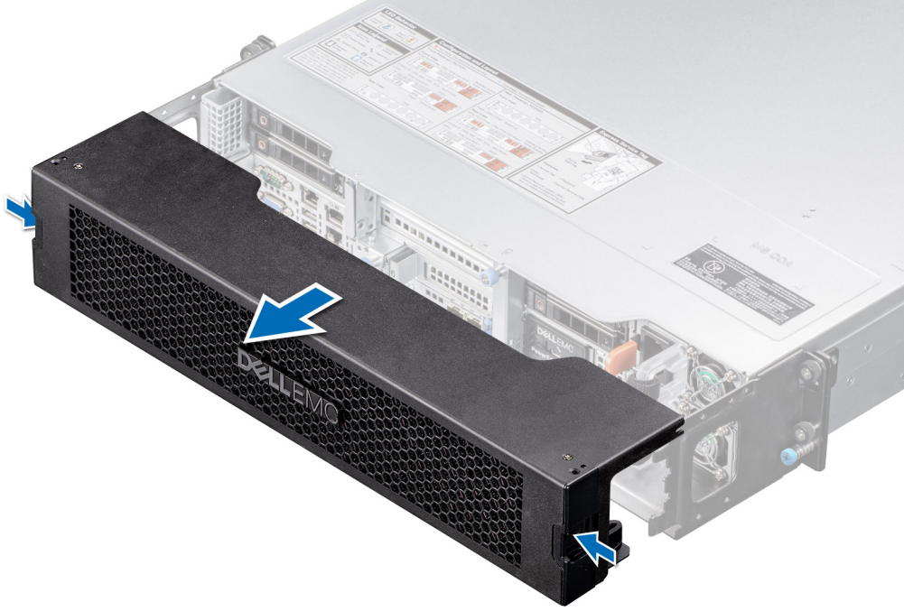
Rakam 27. Ön çerçeve kapağının çıkarılması
