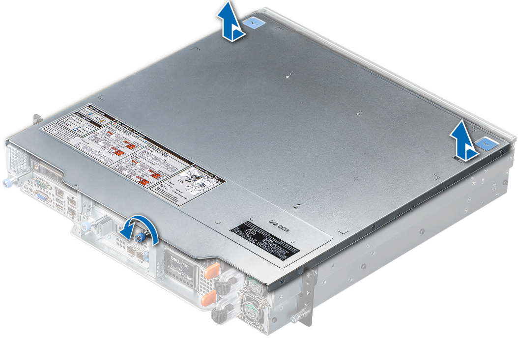
Rakam 33. Sistem kapağının çıkarılması
