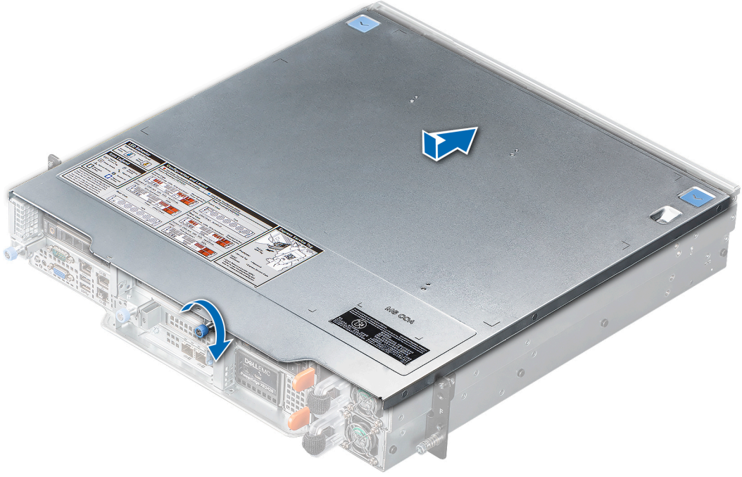
Rakam 34. Sistem kapağının takılması
