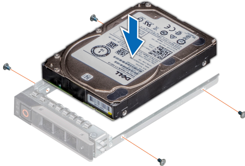
그림 40 . 드라이브 캐리어에 드라이브 설치
