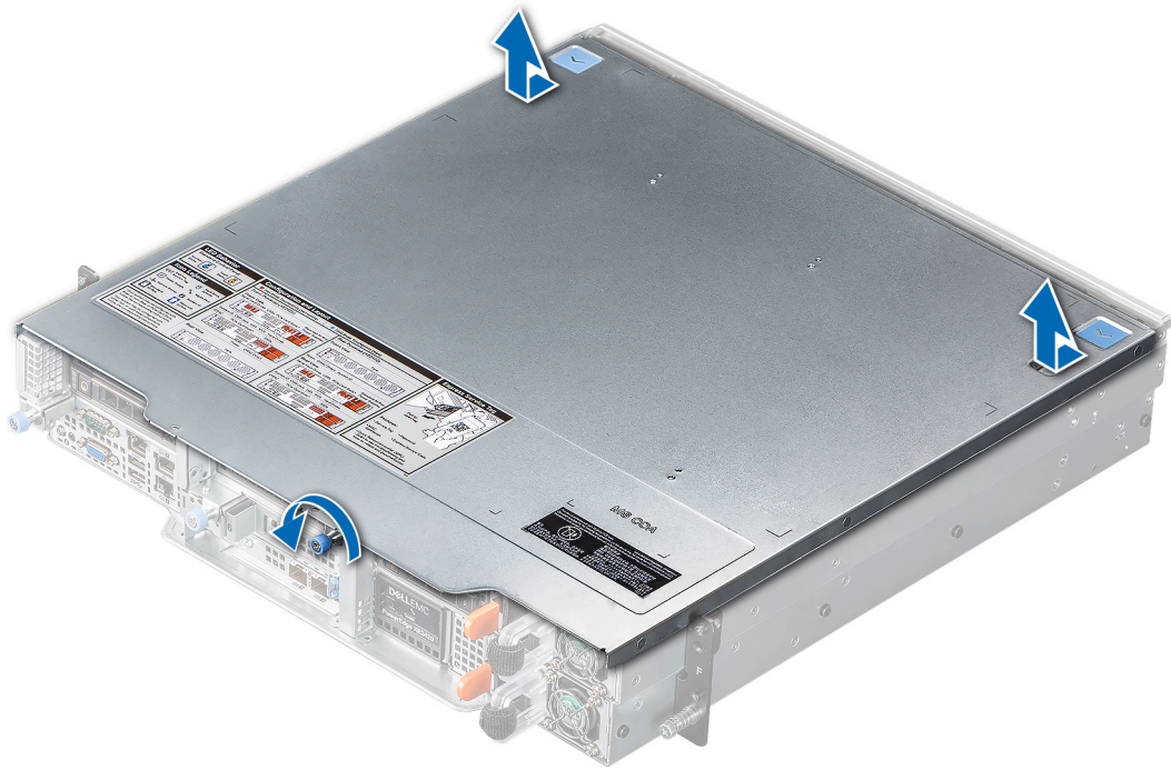
그림 33. 시스템 커버 제거
