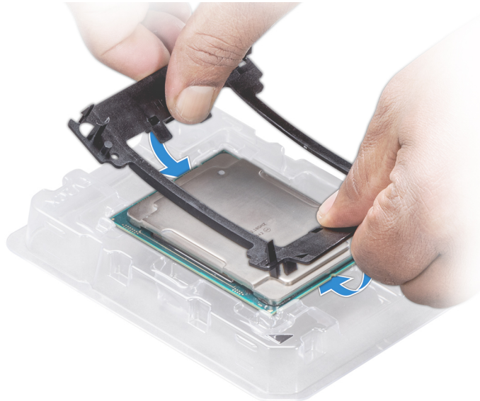
Abbildung 101. Installieren der Prozessor-Halterung
