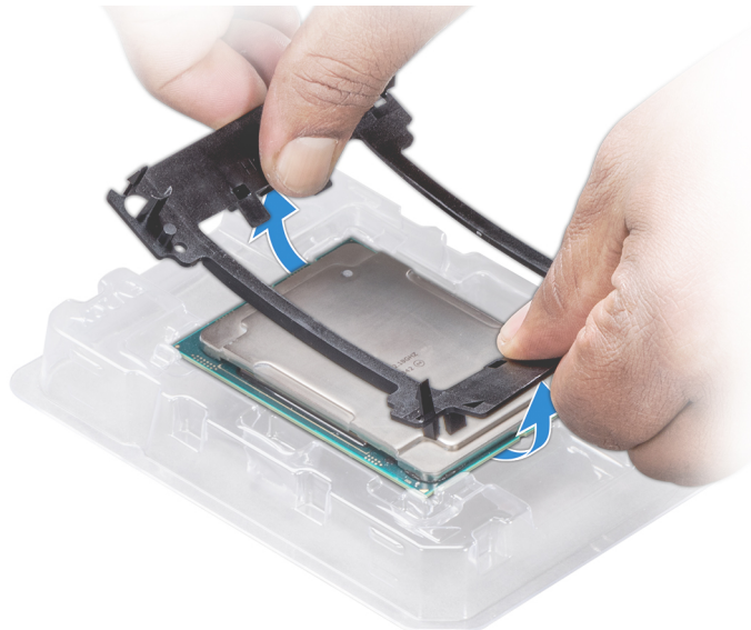
Abbildung 100. Entfernen der Prozessorhalterung
