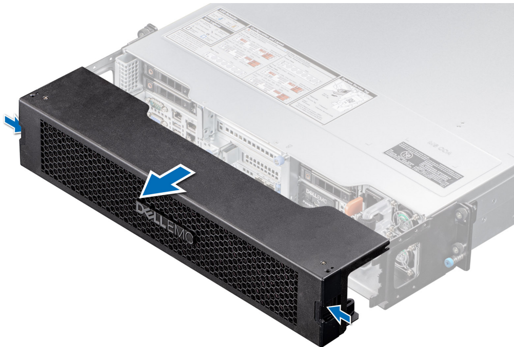
Abbildung 27. Entfernen der Frontabdeckung
