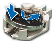
Abbildung 118. Installation der Systembatterie
