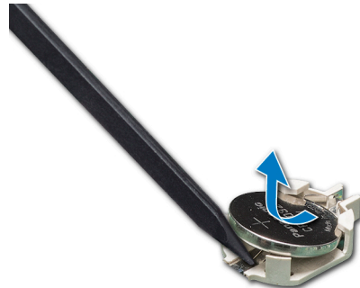
Abbildung 117. Entfernen der Systembatterie
