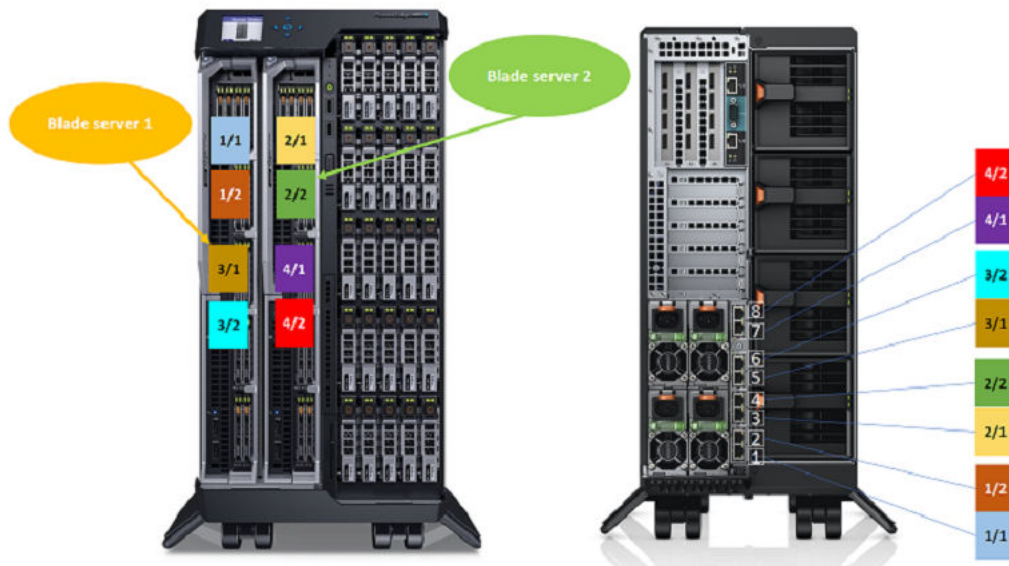
图 24: VRTX 全高刀片端口映射
