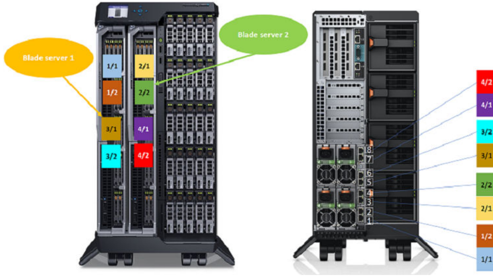
Rakam 24. VRTX tam yükseklikte blade sunucu bağlantı noktası eşlemesi
