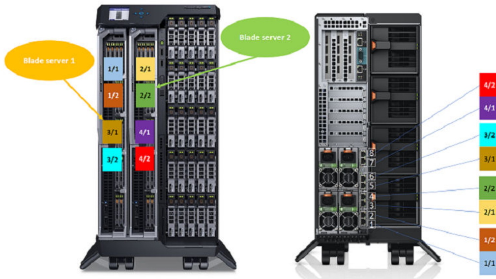
図 24. VRTX フルハイトブレードポートのマッピング
