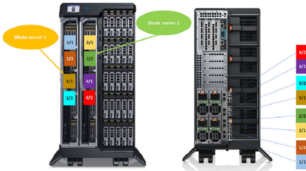
Figure 24. Adressage des ports lames pleine hauteur VRTX
