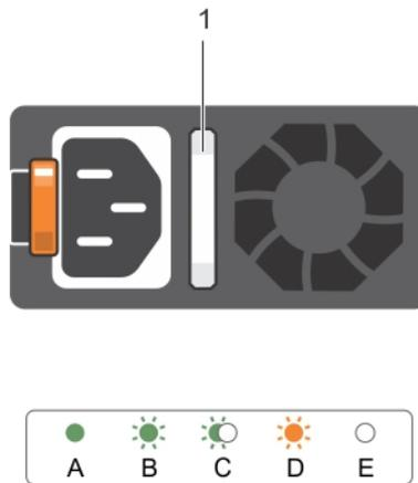
Abbildung 7. Statusanzeige des Wechselstromnetzteils
