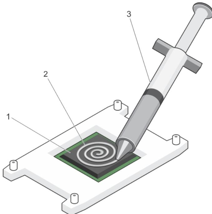
图 68: 在处理器顶部涂抹导热油脂
