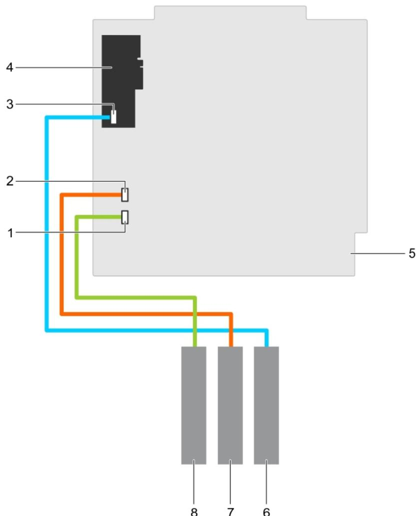
**图 47: 布线 — 光盘驱动器和磁带机**
