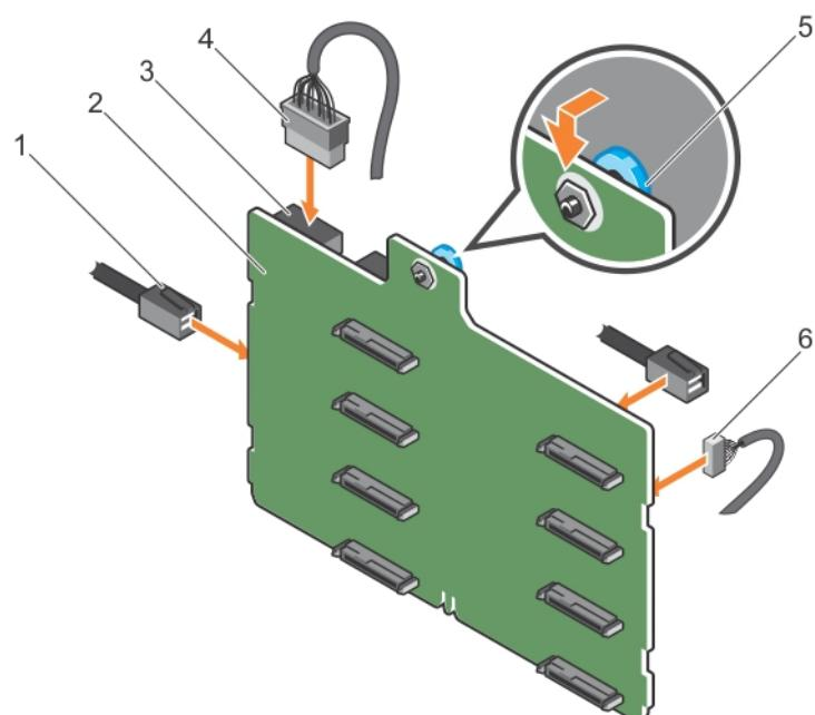
图 99: 安装具有单个 PERC 卡的 3.5 英寸 (x8) SAS/SATA 背板
