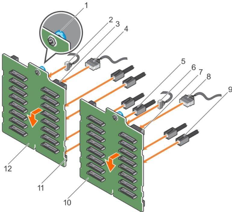
**图 105: 安装具有单个 PERC 卡的 2.5 英寸 (x32) SAS/SATA 背板**
