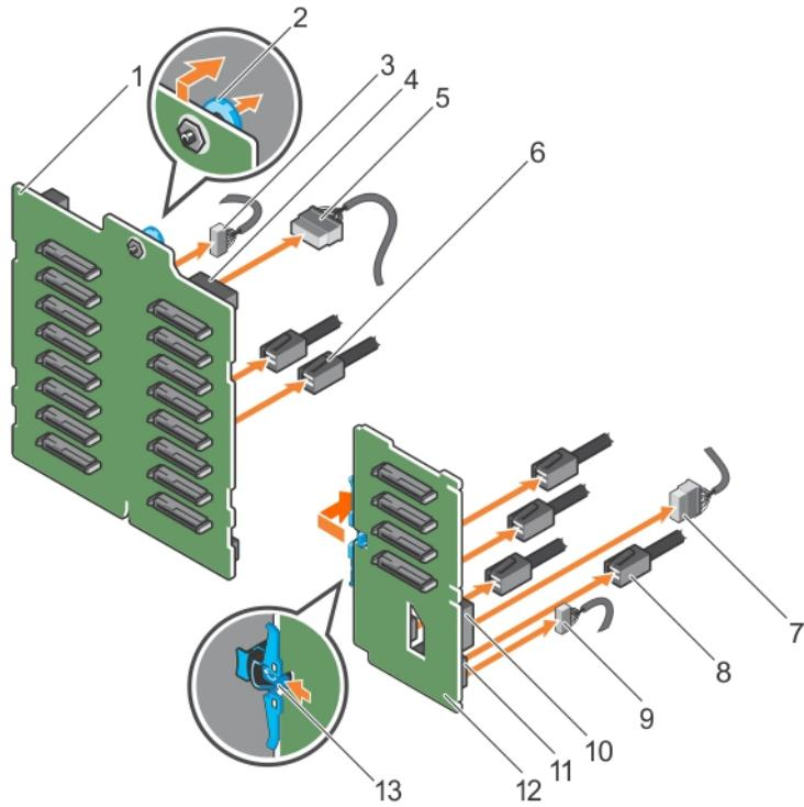
图 91: 卸下 2.5 英寸 (x16) 加 2.5 英寸 (x4) SAS/SATA 背板
