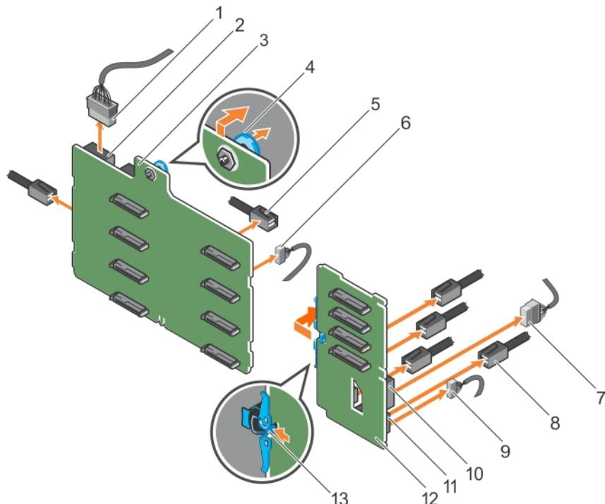
图 85: 卸下 3.5 英寸 (x8) 加 2.5 英寸 (x4) SAS/SATA 背板
