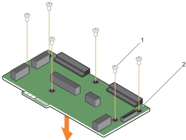
**图 117: 安装配电板**
