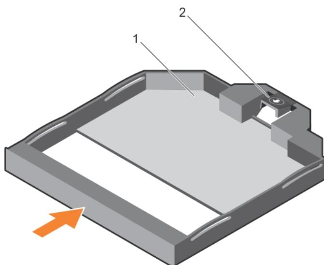
**图 50: 安装细长型光盘驱动器挡片**
