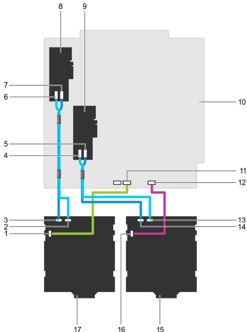
**图 94: 布线 — 具有两个 PERC 卡的 2.5 英寸 (x32) SAS/SATA 背板**
