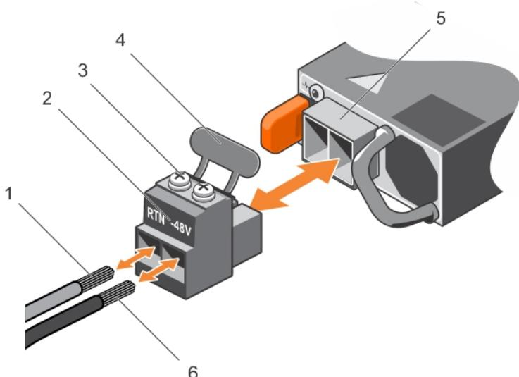
图 73: 组装直流输入电源线
