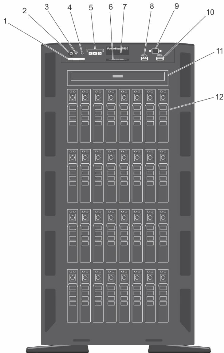
图 2: 前面板 - 2.5 英寸硬盘驱动器机箱
