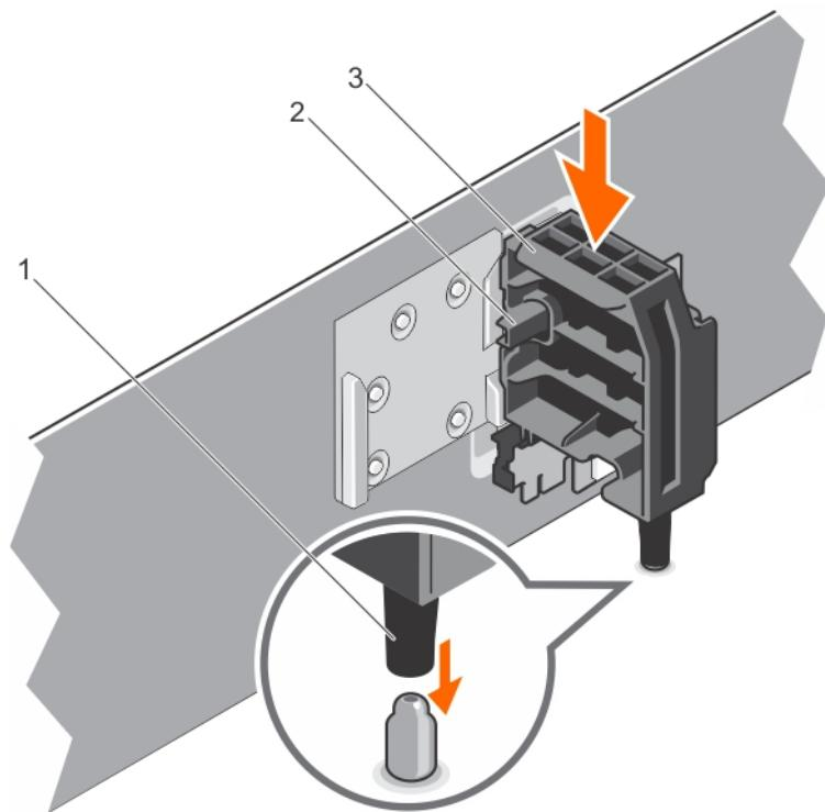
**图 58: 安装 GPU 卡固定器**
