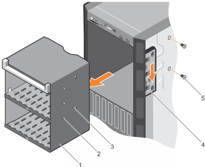
图 32: 卸下可更换托架
