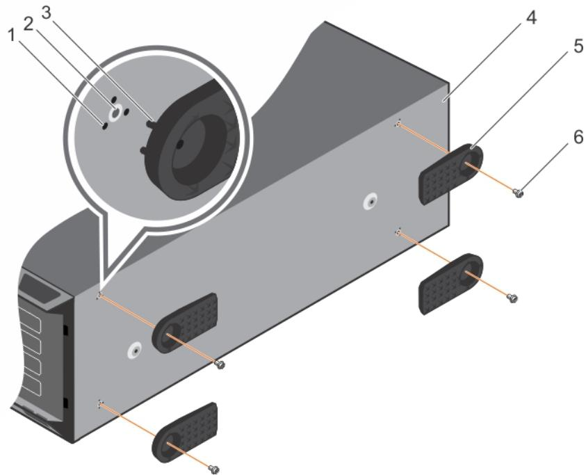
**图 17: 卸下和安装系统支脚**
