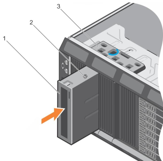
**图 48: 安装光盘驱动器或磁带机**
