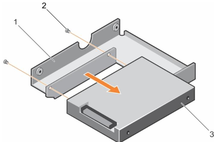
图 41: 从 3.5 英寸硬盘驱动器适配器中卸下 2.5 英寸硬盘驱动器
