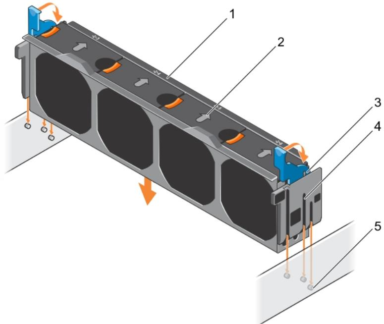
图 28: 安装冷却风扇部件
