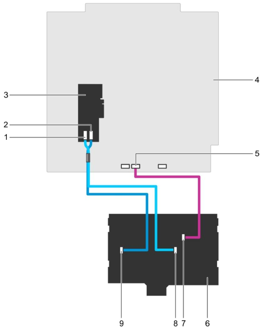
**图 84: 布线 — 具有单个 PERC 卡的 3.5 英寸 (x8) SAS/SATA 背板**
