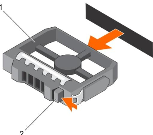
图 38: 卸下 3.5 英寸硬盘驱动器挡片
