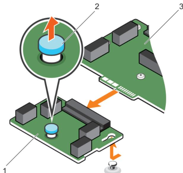
图 115: 卸下电源插入器板
