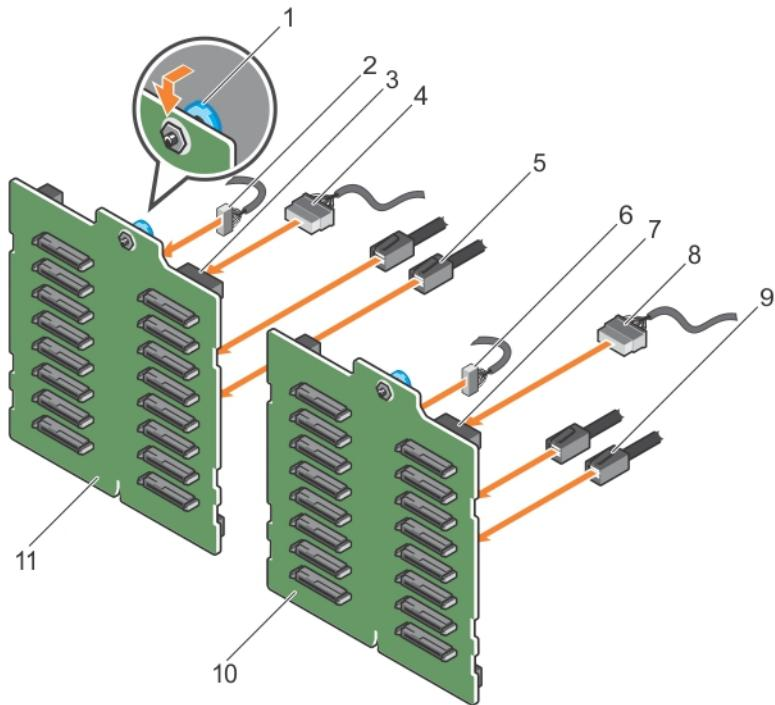
图 104: 安装具有两个 PERC 卡的 2.5 英寸 (x32) SAS/SATA 背板
