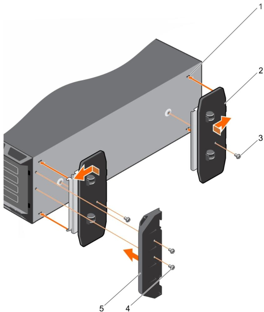
**图 19: 安装脚轮**
