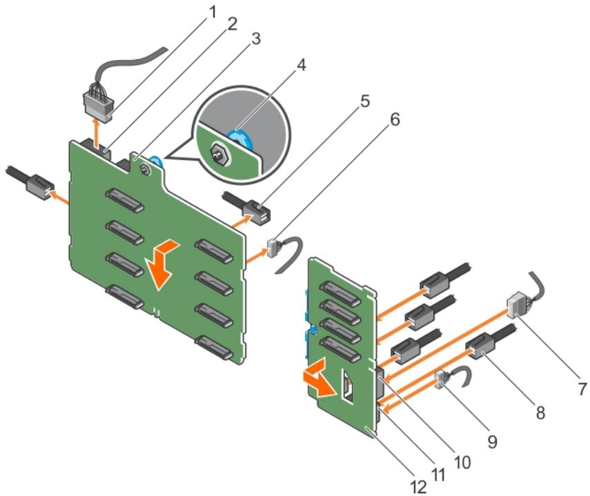
图 100: 安装 3.5 英寸 (x8) 加 2.5 英寸 (x4) SAS/SATA 背板
