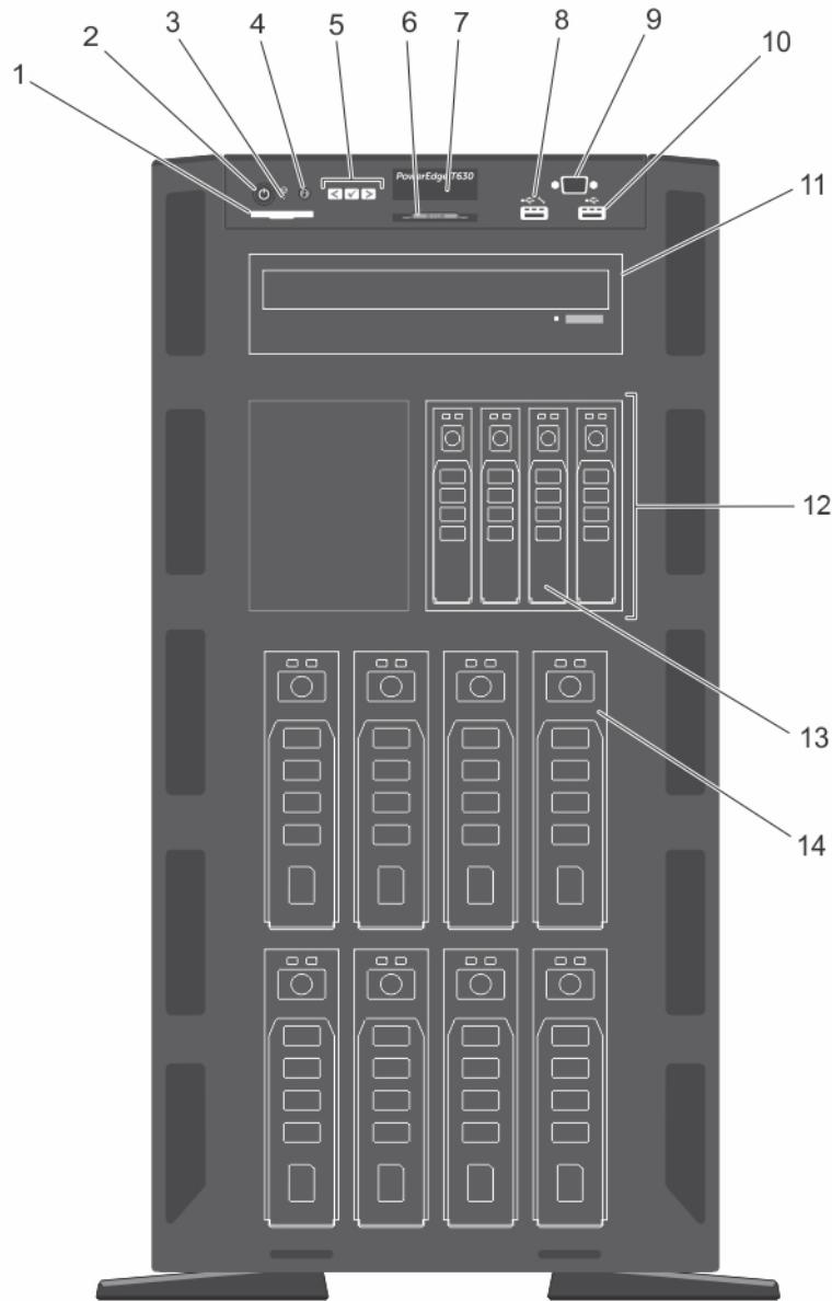
图 3: 前面板 — 3.5 英寸硬盘驱动器加四个 PCIe SSD 机箱
