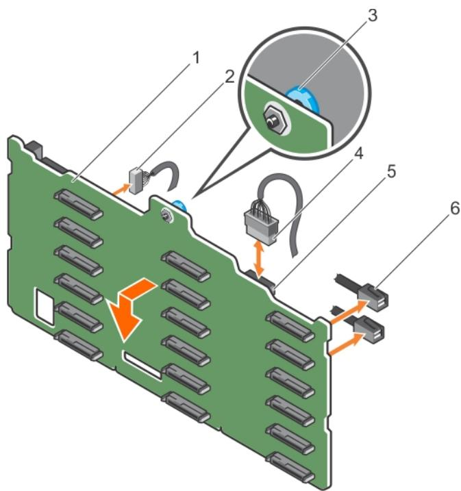
图 101: 安装 3.5 英寸 (x18) SAS/SATA 背板
