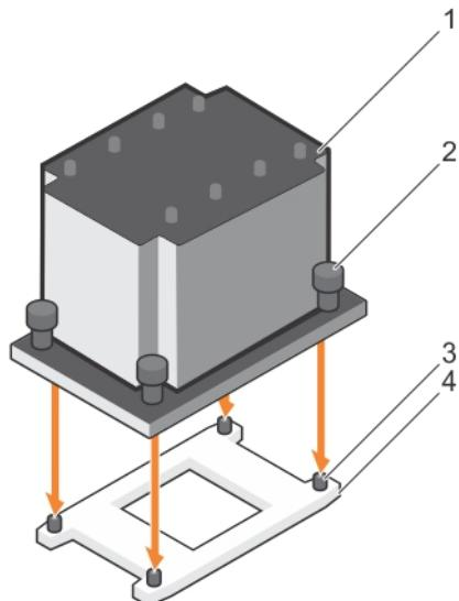
**图 69: 安装散热器**
