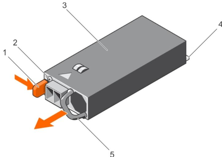
图 74: 拆卸 DC PSU
