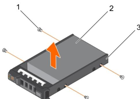
**图 44: 从硬盘托架中卸下硬盘**
