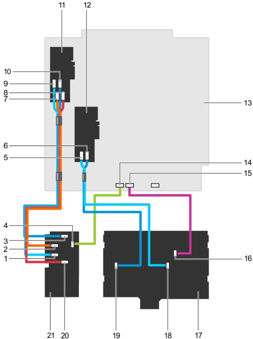
**图 86: 布线—3.5 英寸 (x8) 加 2.5 英寸 (x4) SAS/SATA 背板**
