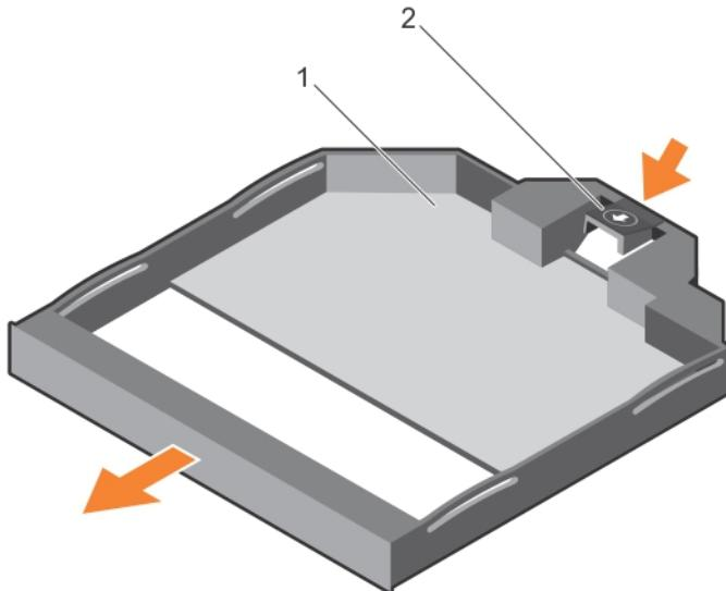
**图 49: 卸下细长型光盘驱动器挡片**
