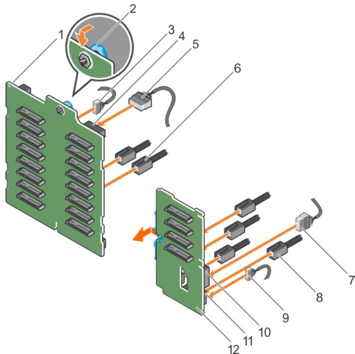
图 103: 安装 2.5 英寸 (x16) 加 2.5 英寸 (x4) SAS/SATA 背板
