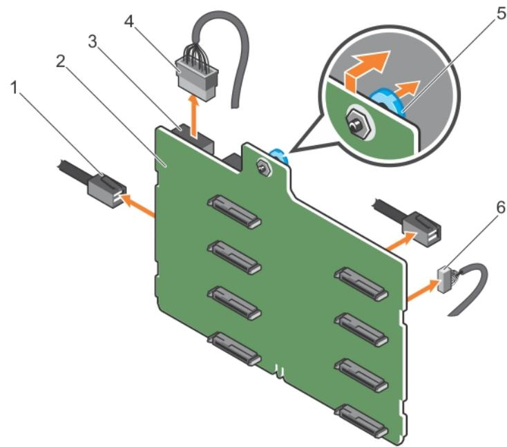
图 83: 卸下具有单个 PERC 卡的 3.5 英寸 (x8) SAS/SATA 背板
