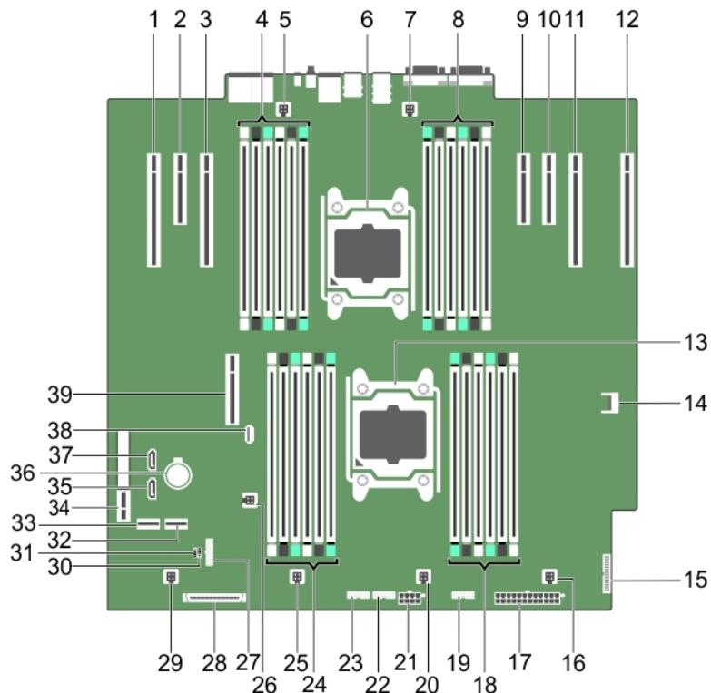
图 119: 系统板跳线和连接器
