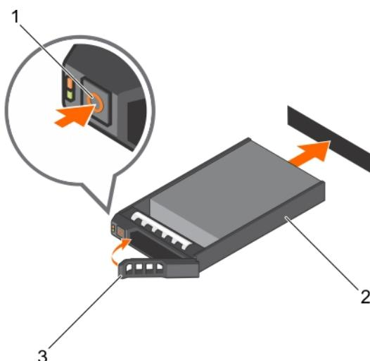
图 35: 安装热插拔硬盘
