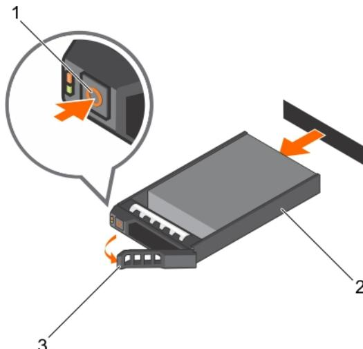
图 34: 卸下热插拔硬盘驱动器或 SSD
