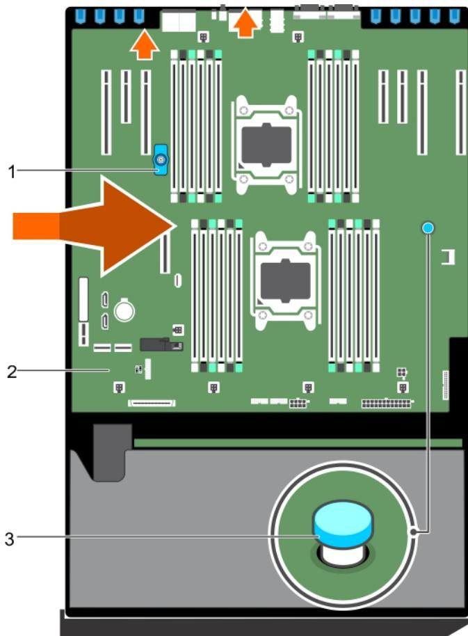
图 113: 安装系统板
