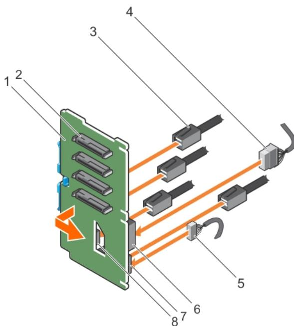
图 97: 安装 PCIe SSD 硬盘驱动器背板
