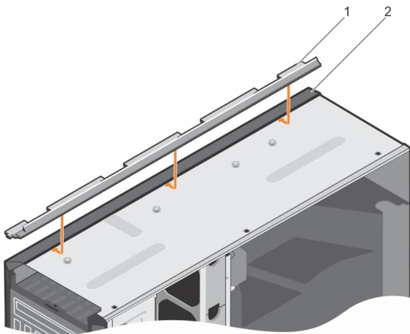
图 10: 安装机架滑盖。
