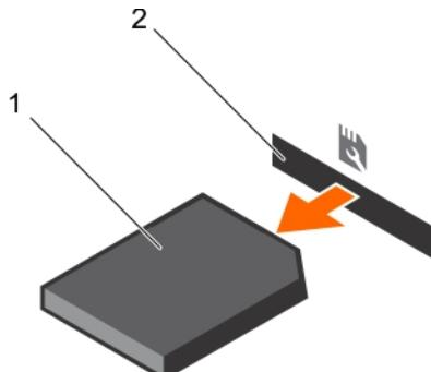
图 106: 卸下 SD vFlash 介质卡
