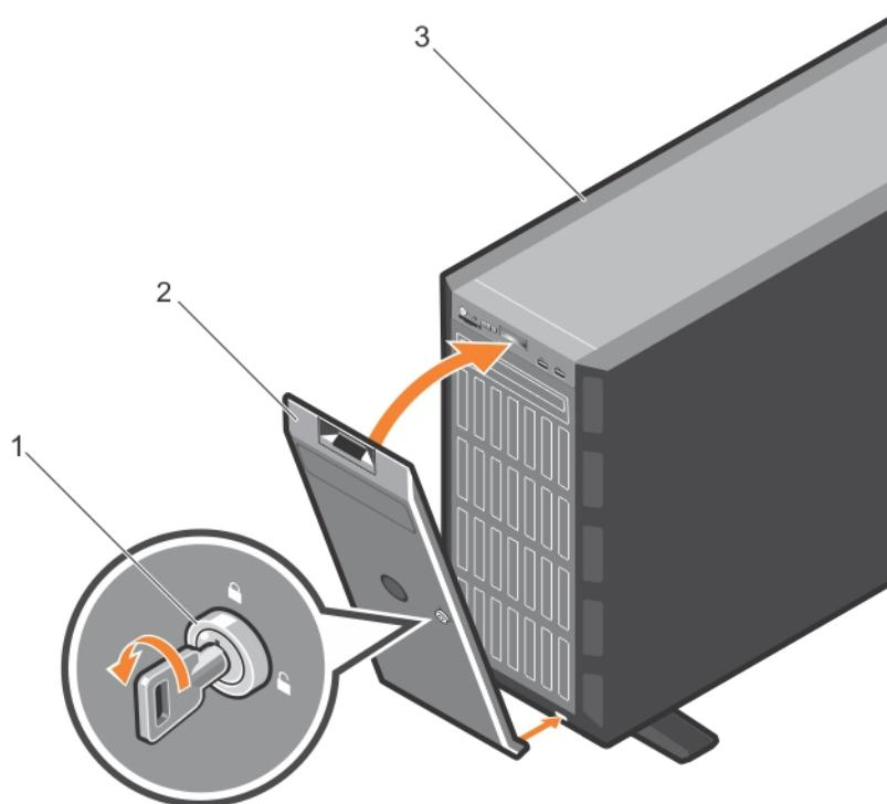
**图 16: 安装前挡板**
