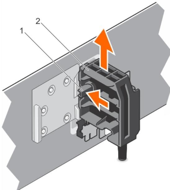
图 57: 卸下 GPU 卡固定器
