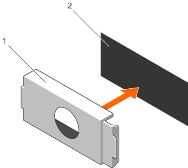
图 77: 安装 PSU 挡片
