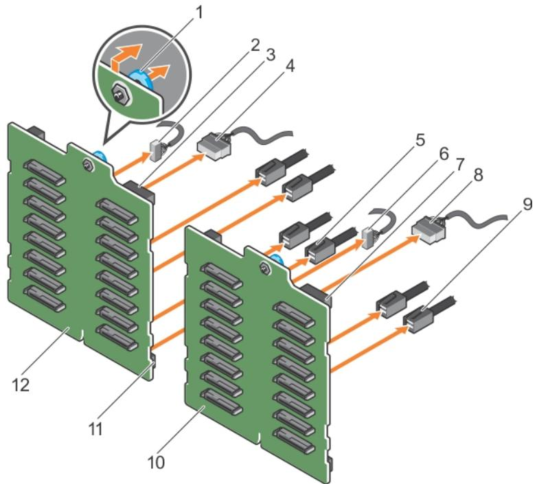
图 95: 卸下具有单个 PERC 卡的 2.5 英寸 (x32) SAS/SATA 背板
