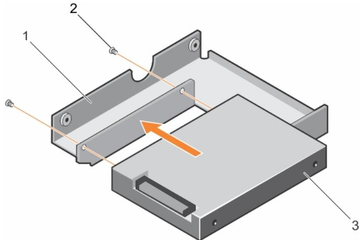
图 40: 将 2.5 英寸硬盘驱动器安装到 3.5 英寸硬盘驱动器适配器中
