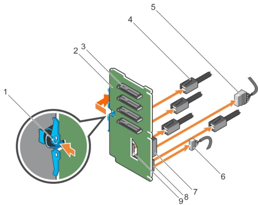
**图 80: 卸下 PCIe SSD 硬盘驱动器背板**
