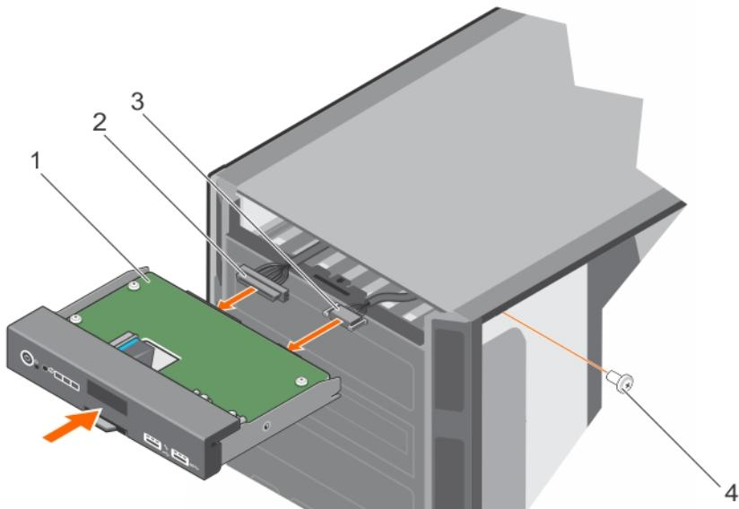
图 110: 安装控制面板部件
