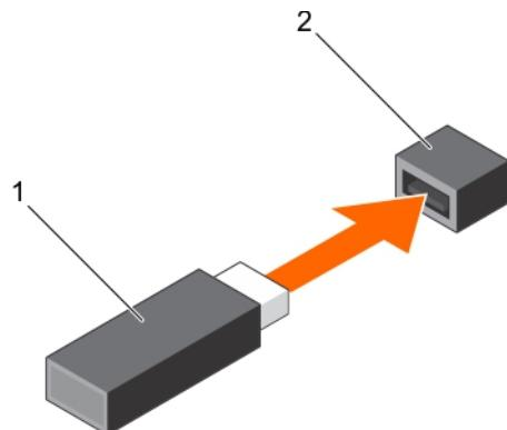
图 52: 安装内置 USB 闪存盘
