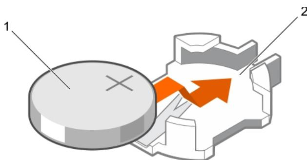
**图 79: 安装系统电池**
