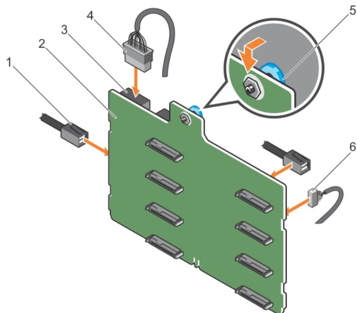
图 98: 安装 3.5 英寸 (x8) SAS/SATA 背板
