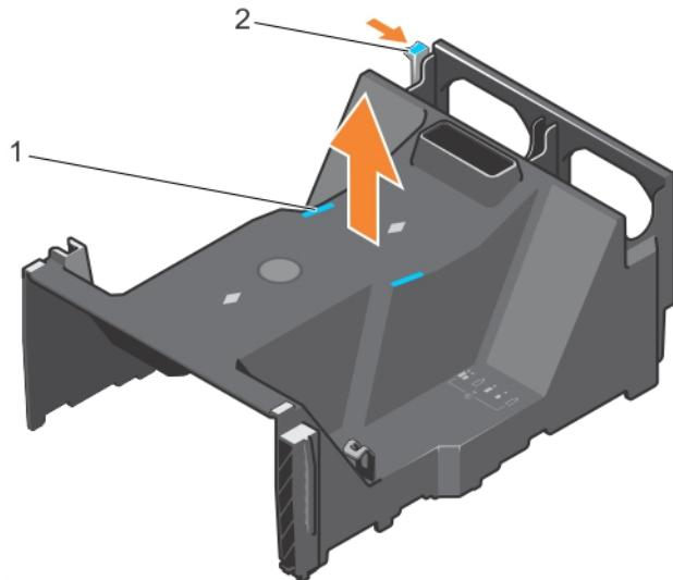
图 23: 卸下冷却导流罩
