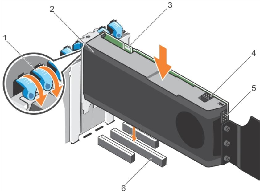
**图 60: 安装 GPU 卡**
