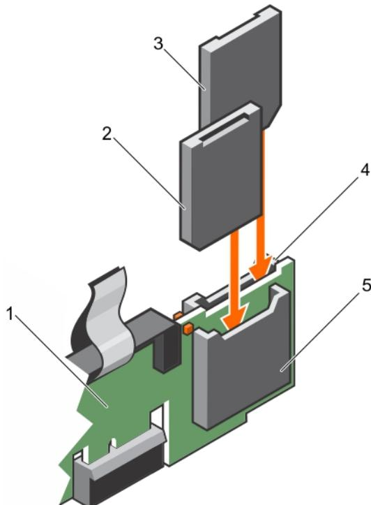
图 63: 安装内部 SD 卡
