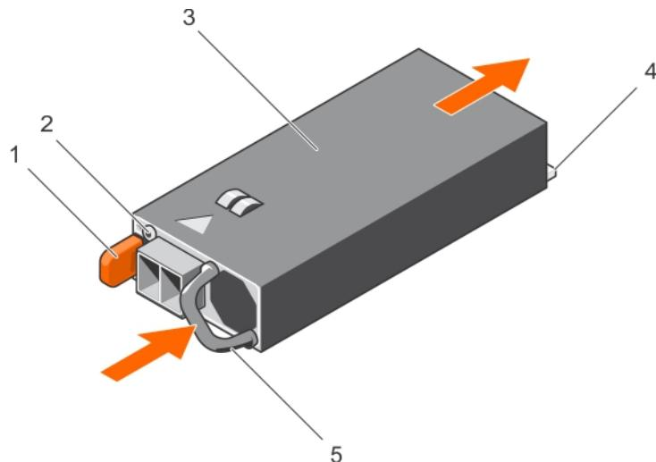
**图 75: 安装直流 PSU**
