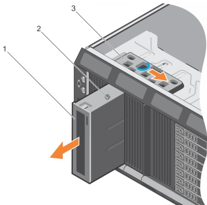
**图 46: 卸下光盘驱动器或磁带机**
