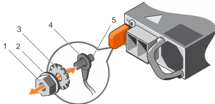
**图 72: 组装和连接安全接地线**
