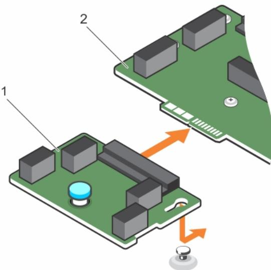
图 118: 安装电源插入器板
