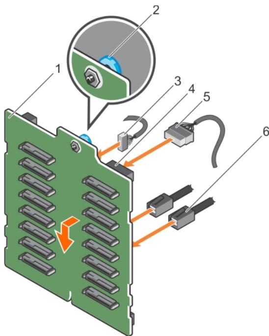
图 102: 安装 2.5 英寸 (x16) SAS/SATA 背板
