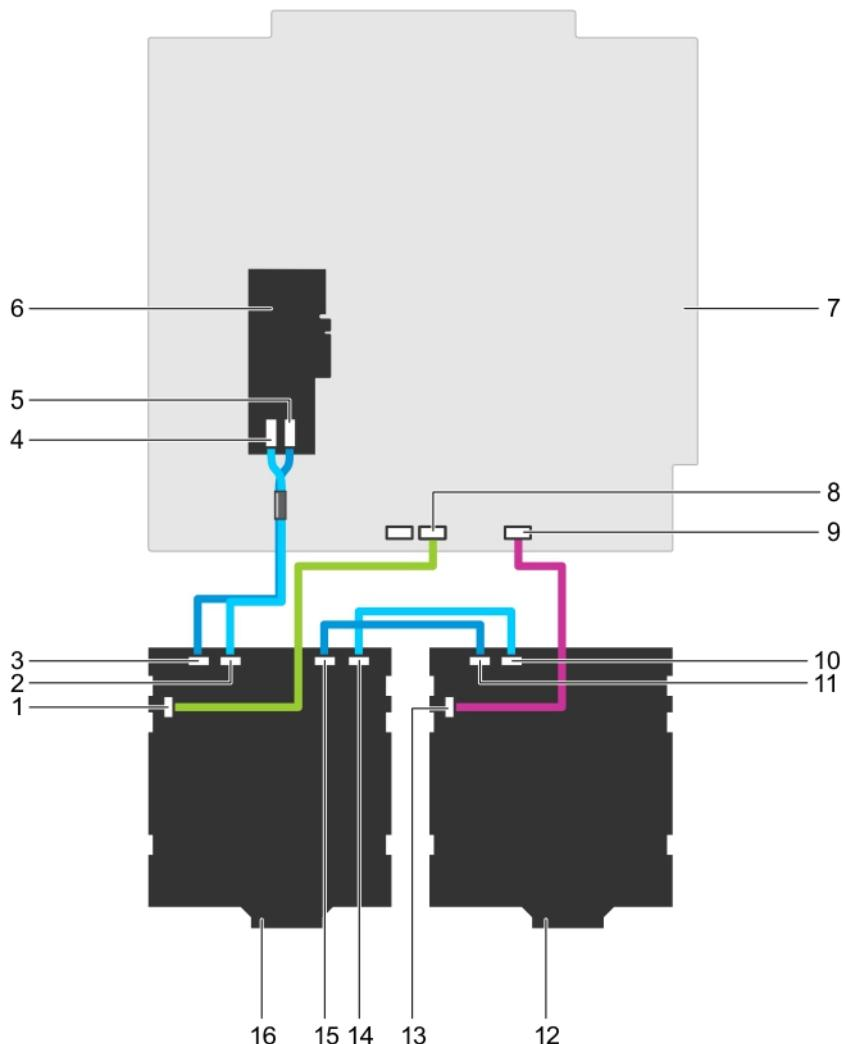
**图 96: 布线 — 具有单个 PERC 卡的 2.5 英寸 (x32) SAS/SATA 背板**
