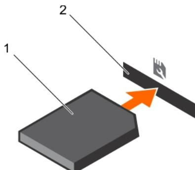
图 107: 安装 SD vFlash 介质卡
