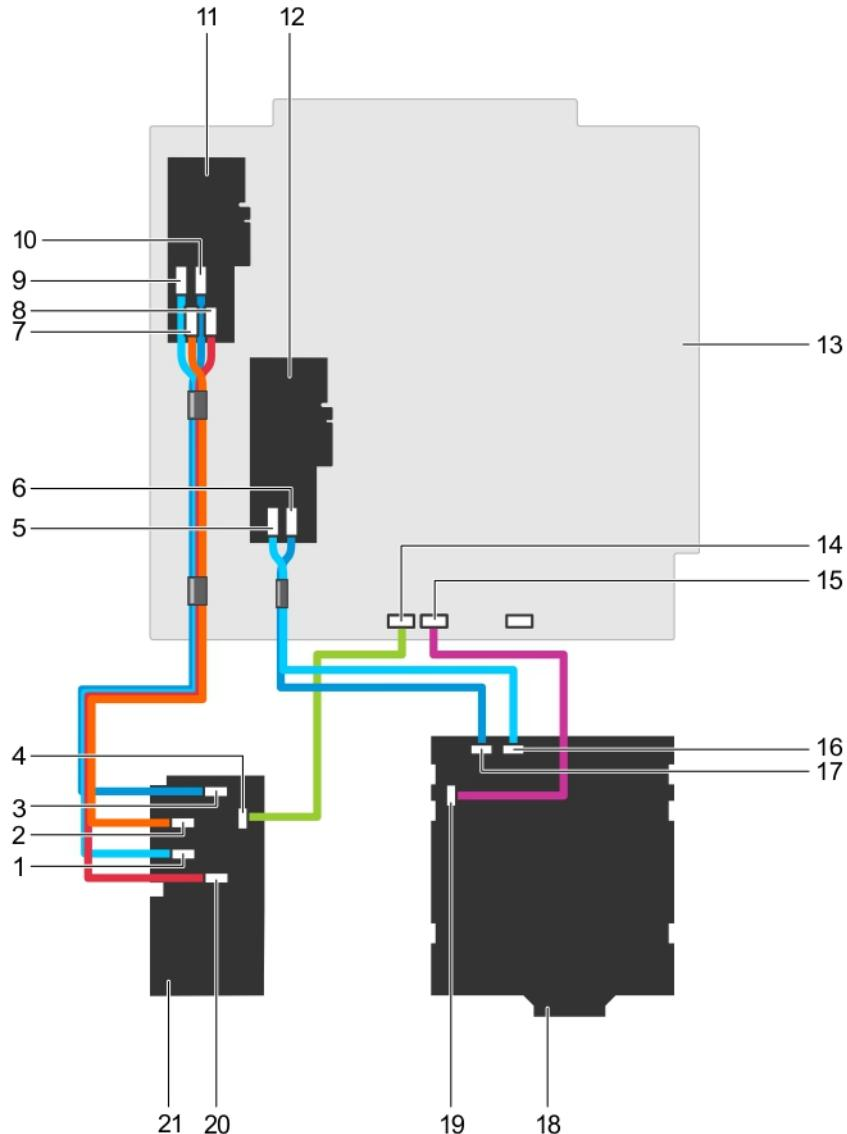
图 92: 布线 — 2.5 英寸 (x16) 加 2.5 英寸 (x4) SAS/SATA 背板
