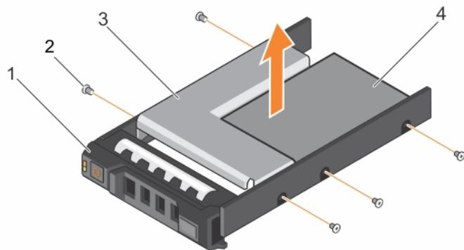
**图 43: 从 3.5 英寸可热插拔硬盘驱动器托盘卸下 3.5 英寸可热插拔硬盘驱动器适配器**
