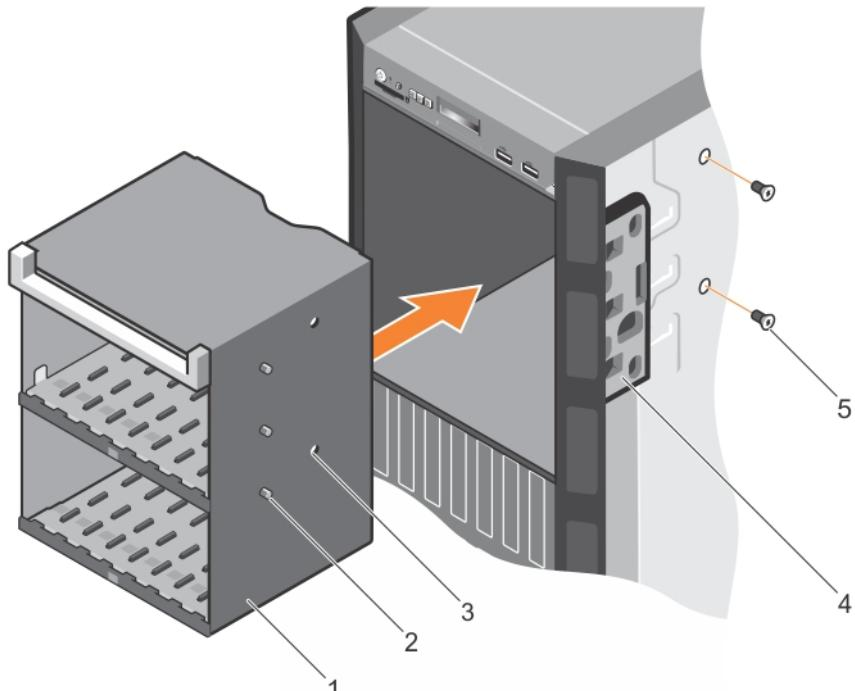
**图 33: 安装可更换托架**
