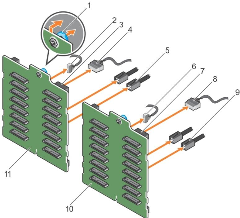
图 93: 卸下具有两个 PERC 卡的 2.5 英寸 (x32) SAS/SATA 背板
