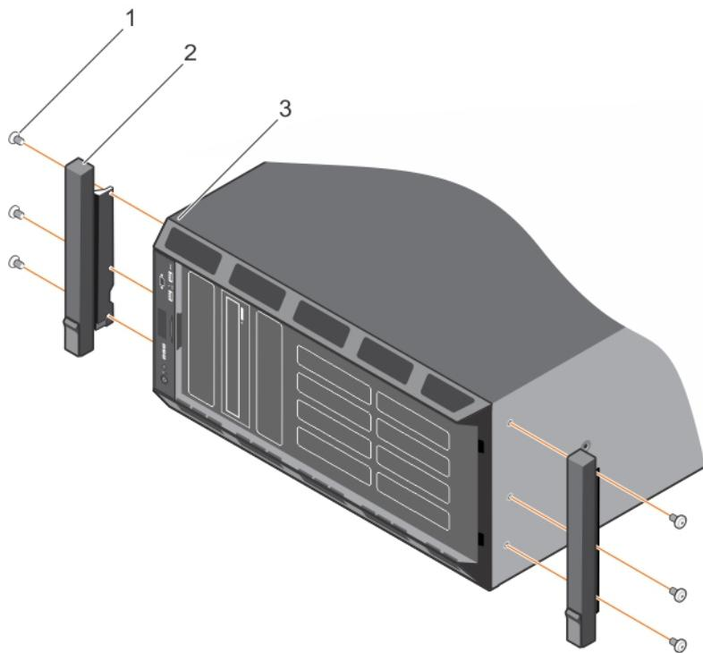
**图 13: 卸下机架吊耳**
