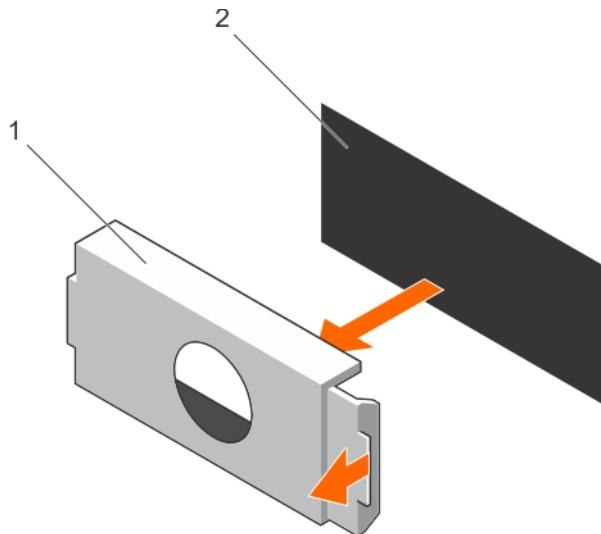
图 76: 卸下 PSU 挡片
