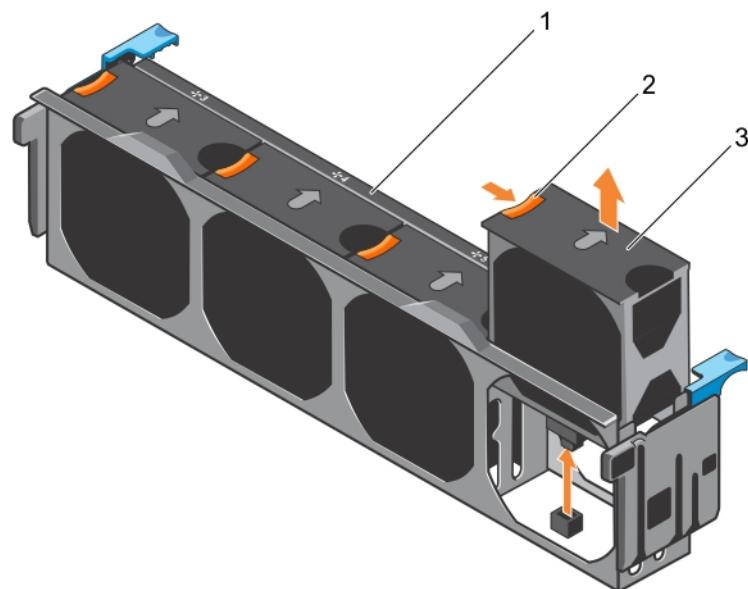
图 25: 在冷却风扇部件中卸下冷却风扇
