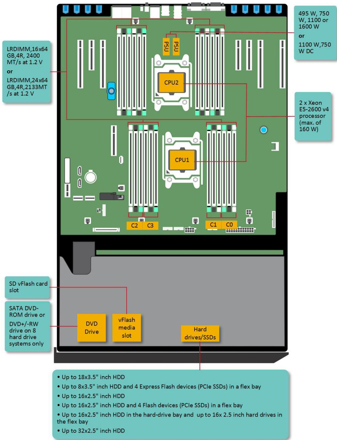
图 1: PowerEdge T630 支持的配置
