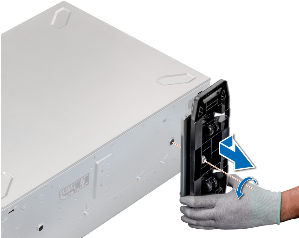
Rakam 21. Tekerleklerin çıkarılması
