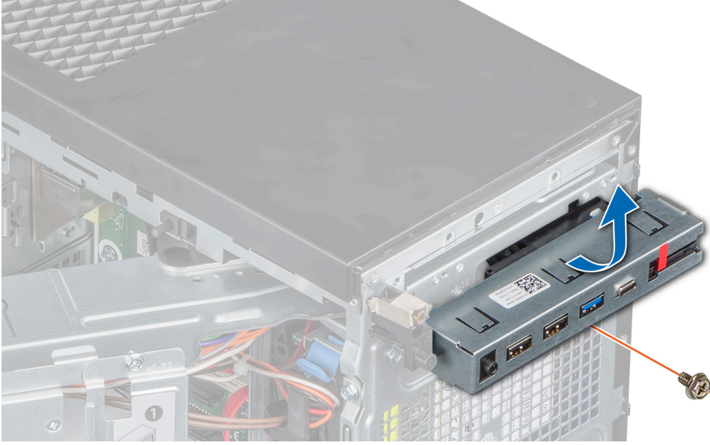
Rakam 52. Kontrol panelinin çıkarılması
