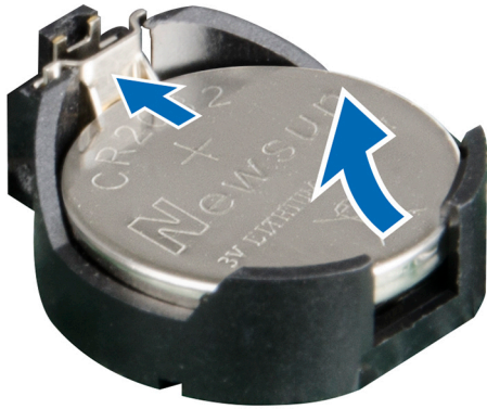
圖 48. 卸下系統電池
