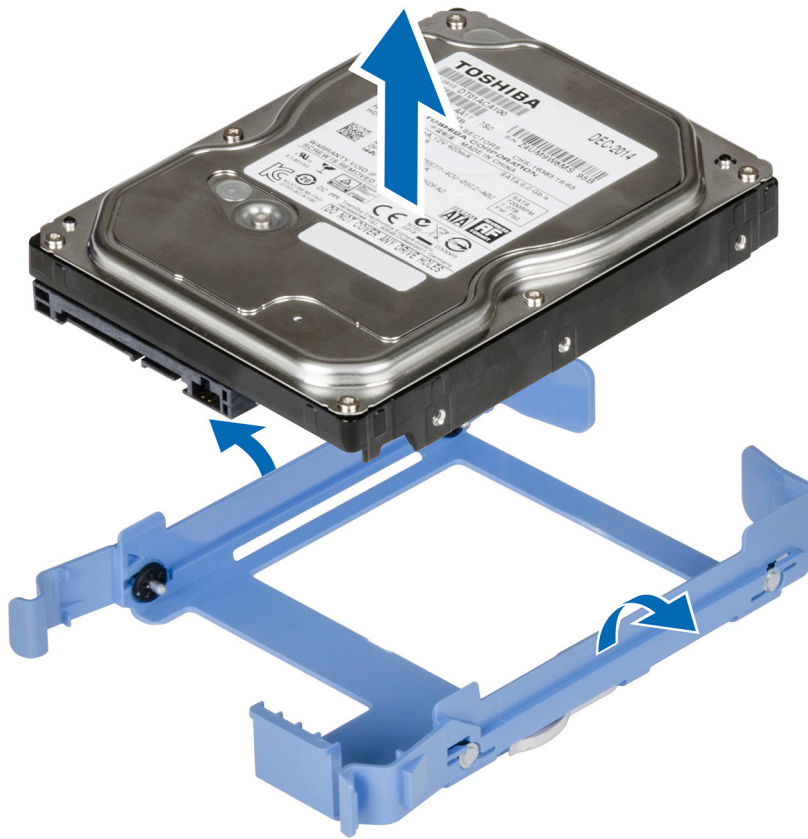
圖 26. 從硬碟承載器卸下硬碟
