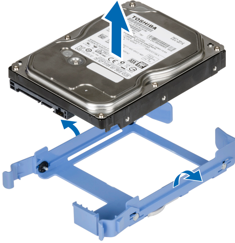
Rakam 26. Sabit sürücünün sabit sürücü taşıyıcısından çıkarılması
