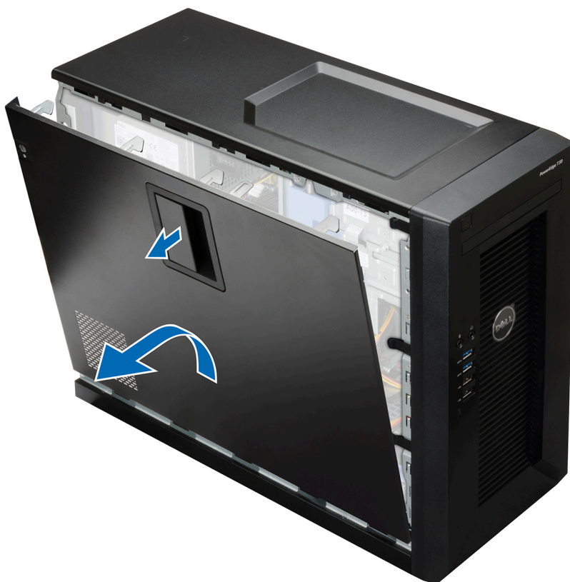
Figura 7. Remover a tampa do sistema
