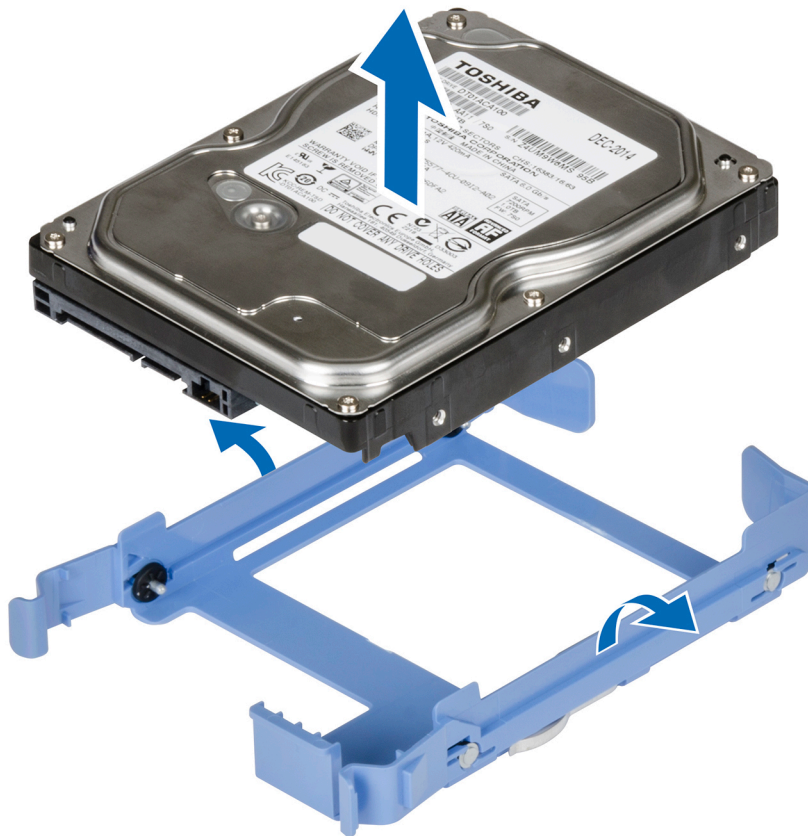
Figura 26. Remover um disco rígido de um suporte de disco rígido
