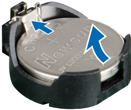
Figura 48. Remover a bateria do sistema
