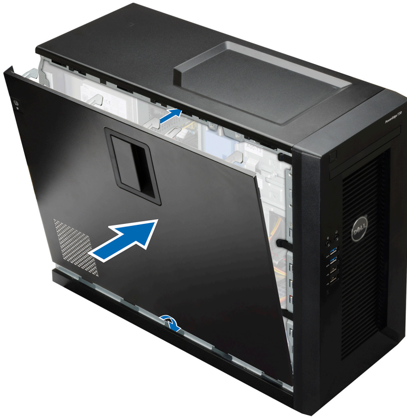
Figura 8. Instalar a tampa do sistema
