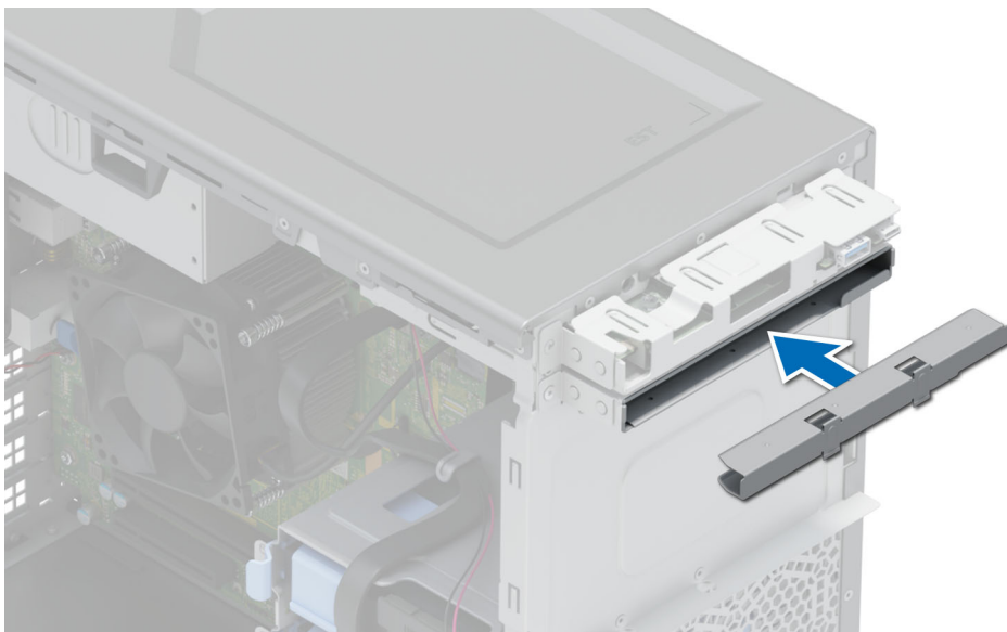
Ilustración 25. Instalación de las unidades ópticas de relleno en el compartimiento de unidades ópticas
