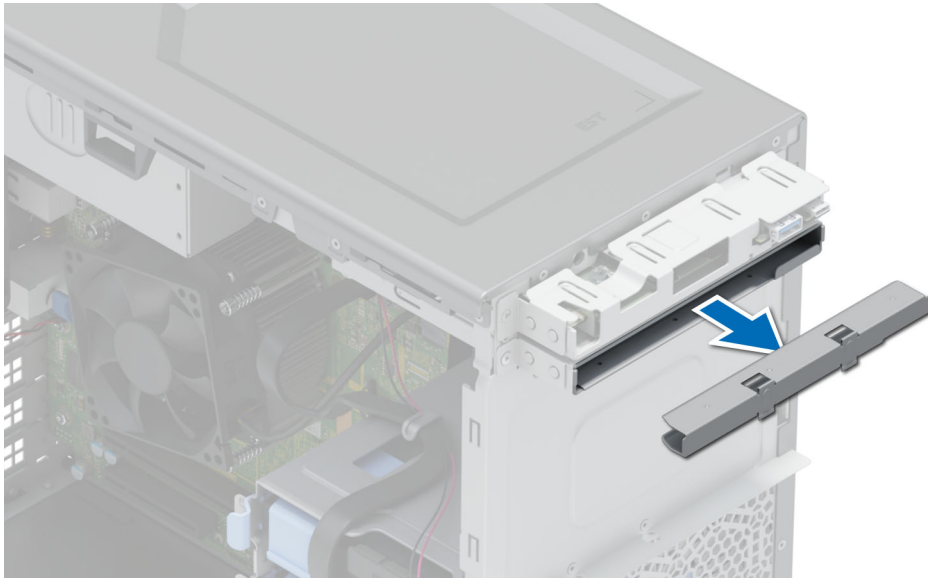
Ilustración 23. Extracción de las unidades ópticas de relleno del compartimento de unidades ópticas
