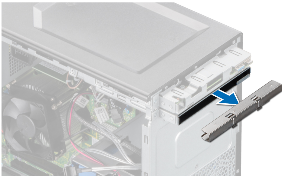
圖 18. 從光碟機固定框架卸下光碟機擋片
