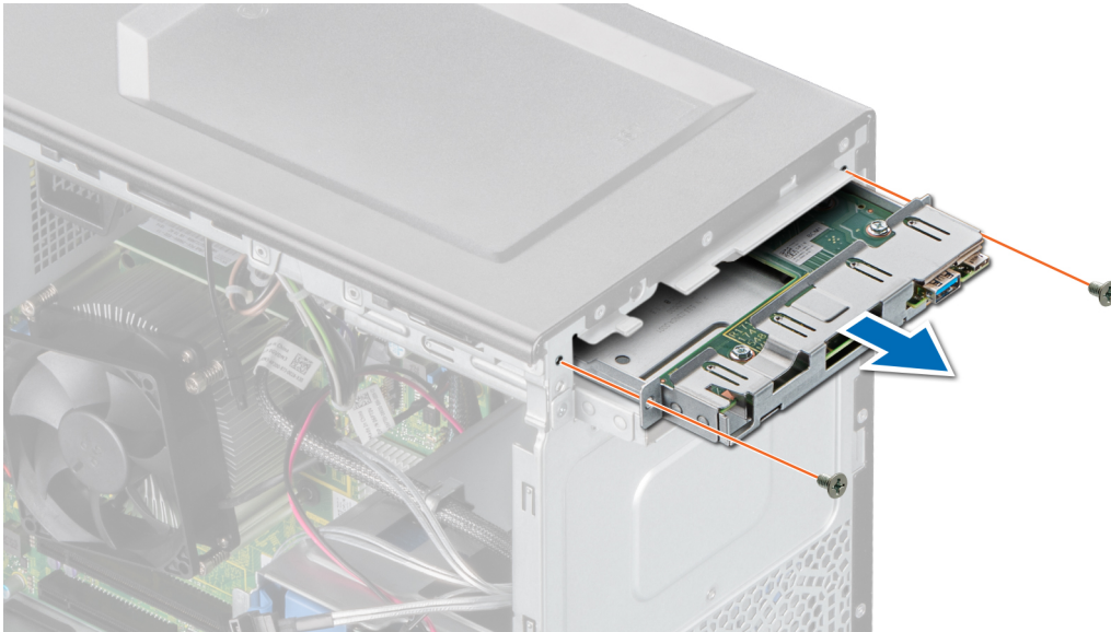
圖 54. 卸下控制面板固定框架
