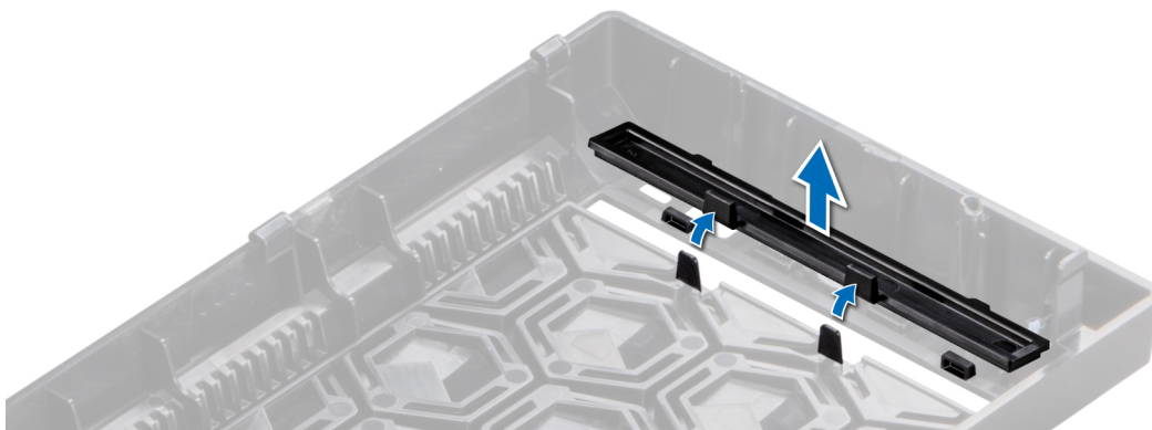
圖 17. 從前蓋卸下光碟機擋片
