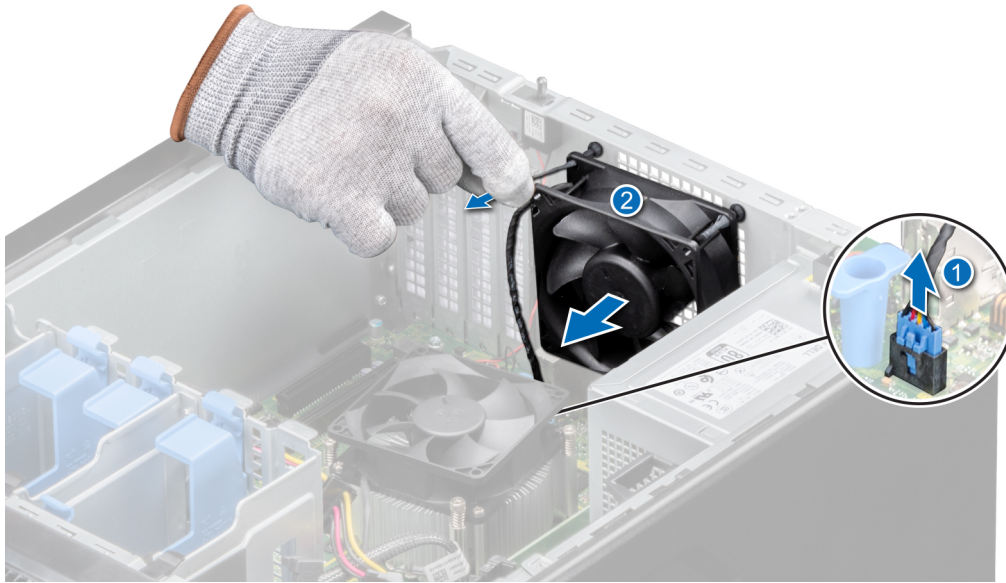
圖 26. 卸下散熱風扇
