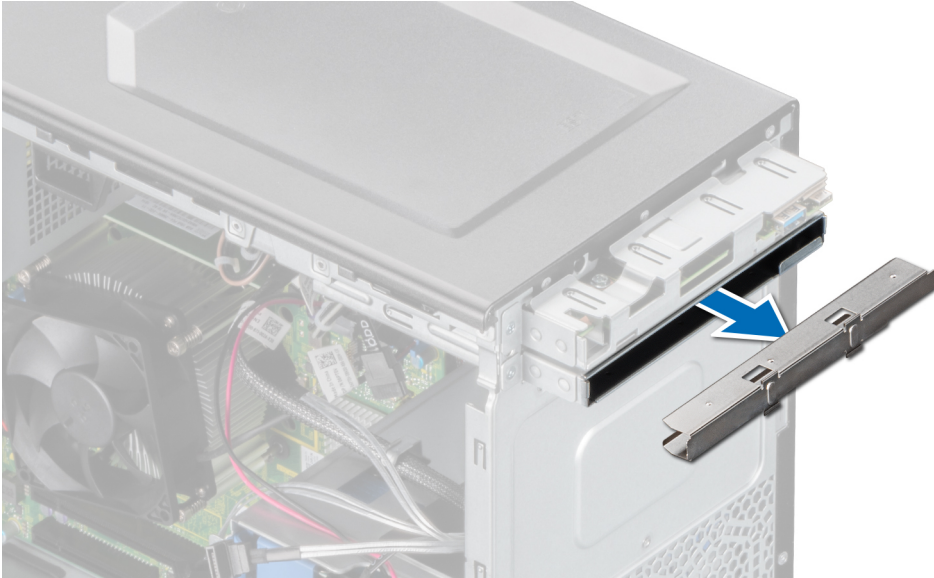
Rakam 18. Optik sürücü dolgusunun optik sürücü kafesinden çıkarılması
