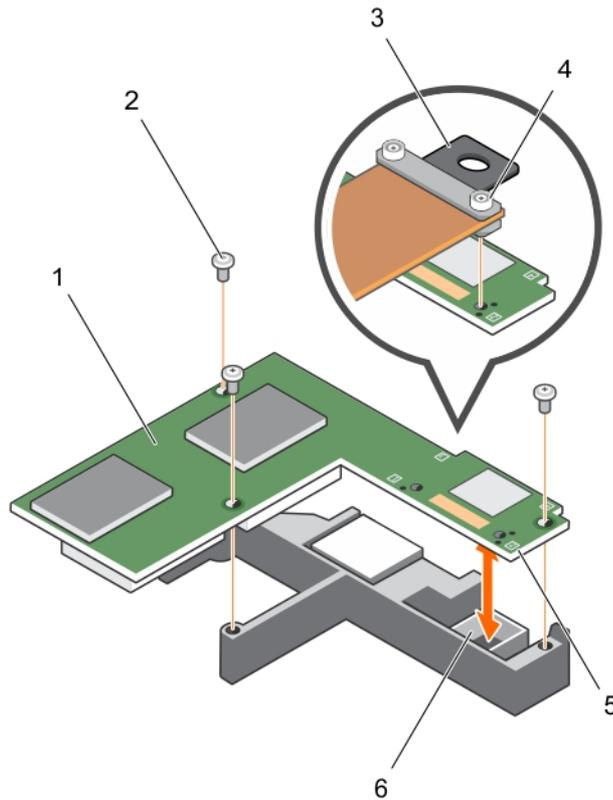
**Figura 21. Extracción e instalación de la tarjeta PERC FD33xD**
