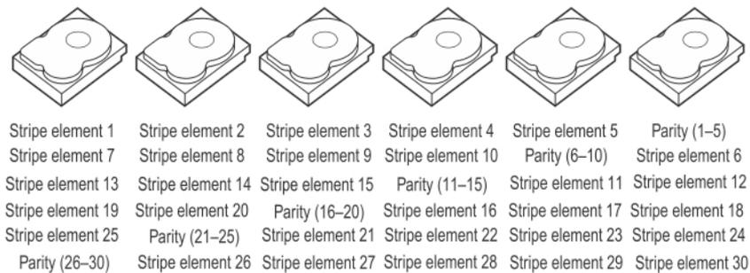
Figura 26. Ejemplo de paridad distribuida (RAID 5)
