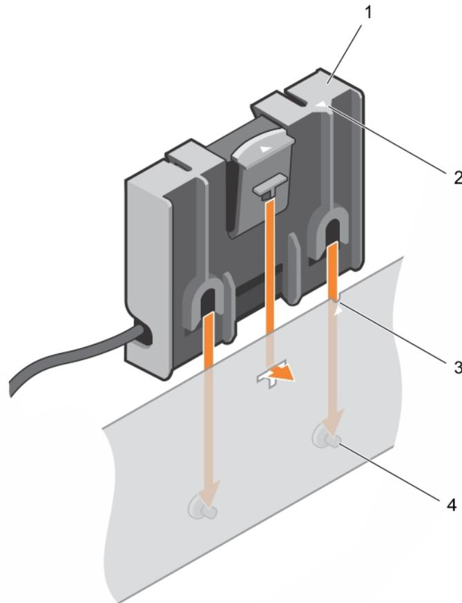
**Figura 20. Colocación del portabatería**
