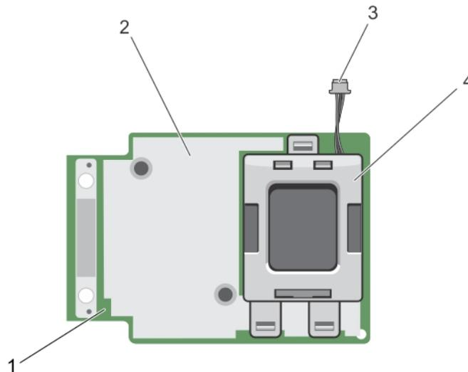
**Figura 4. Características de la tarjeta minimonolítica PERC H730/H730P**
