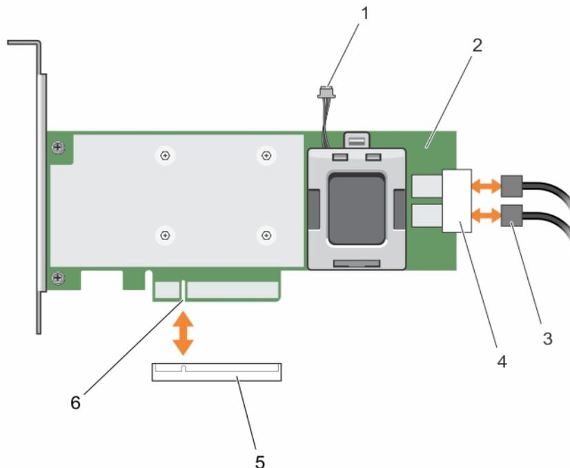
**Figura 10. Extracción e instalación de la tarjeta PERC 9**
