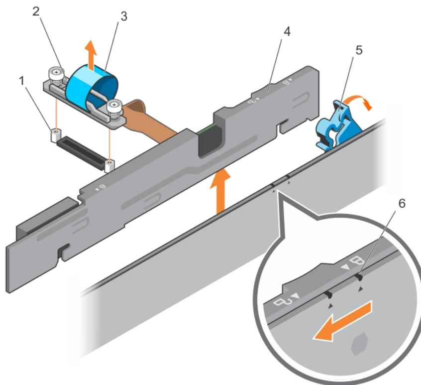
**Figura 14. Extracción e instalación de una tarjeta reducida H730P**
