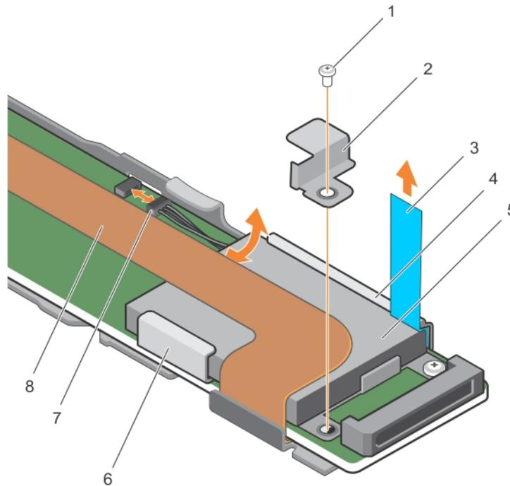
**Figura 15. Extracción de la batería**
