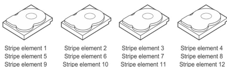
Figura 24. Ejemplo de seccionamiento de discos (RAID 0)
