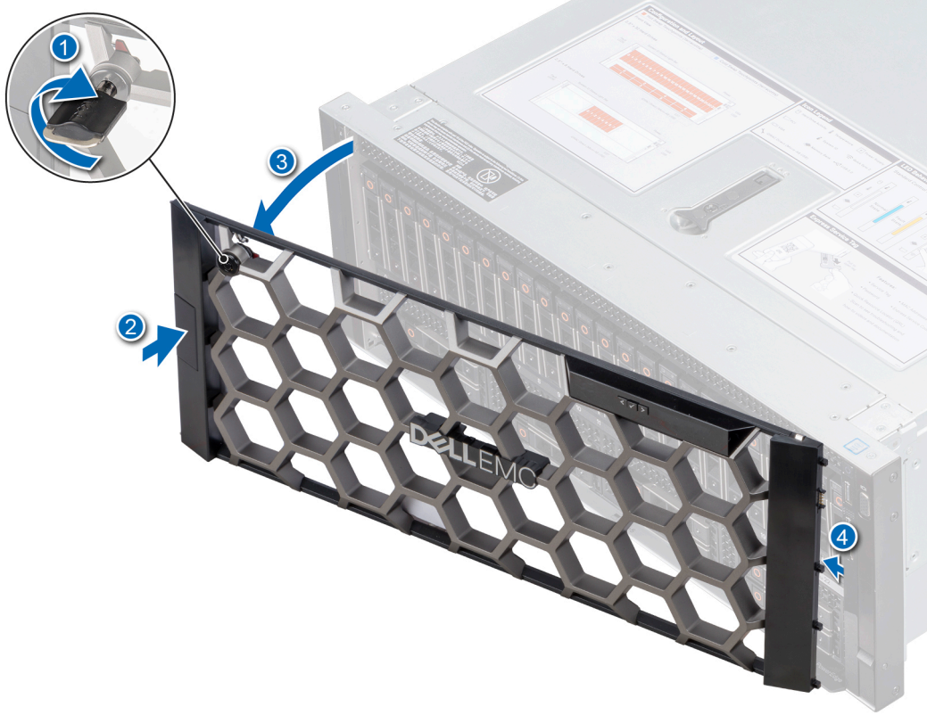
Rakam 19. LCD panelli isteğe bağlı ön çerçeveyi çıkarma
