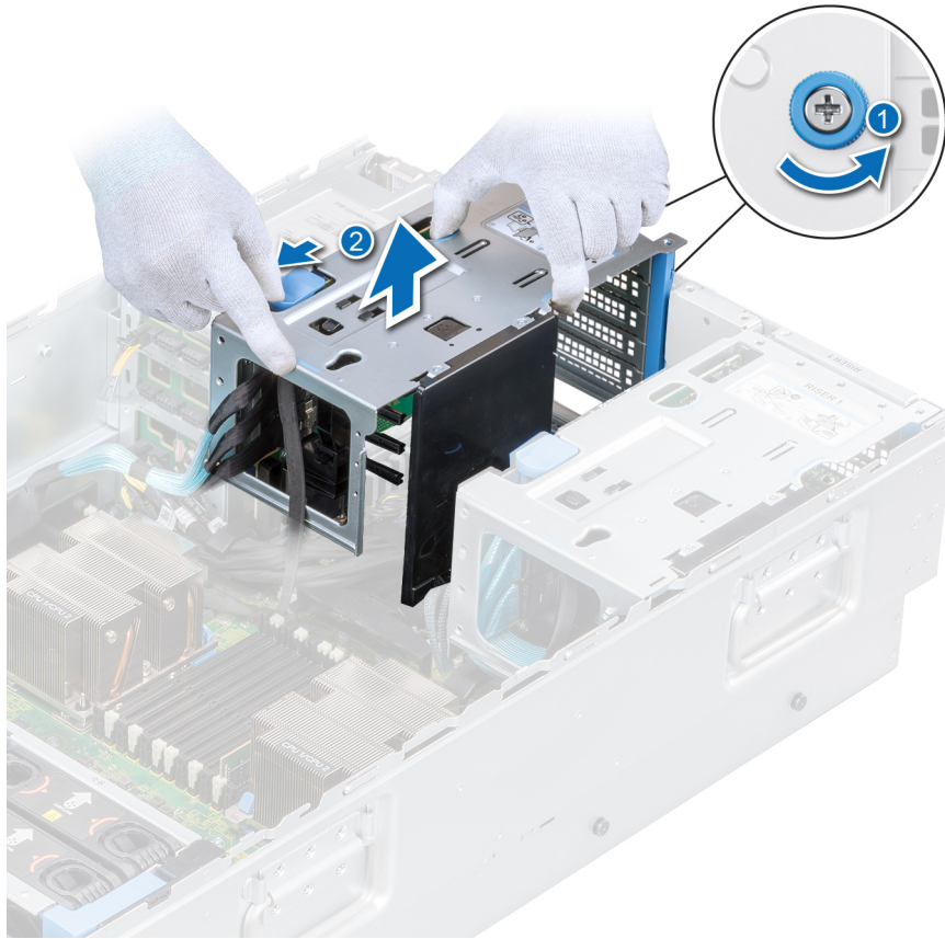
Abbildung 85. Entfernen von PCIe-x8-Riser 2
