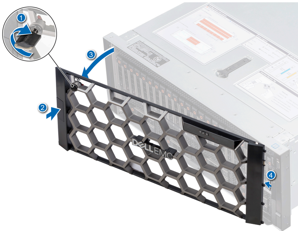
Abbildung 19. Entfernen der optionalen Frontverkleidung mit dem LCD-Display
