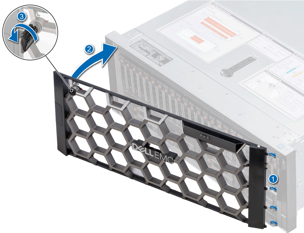
Abbildung 20. Installieren der optionalen Frontverkleidung mit dem LCD-Display
