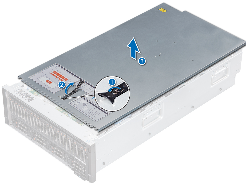
Abbildung 27. Entfernen der Systemabdeckung
