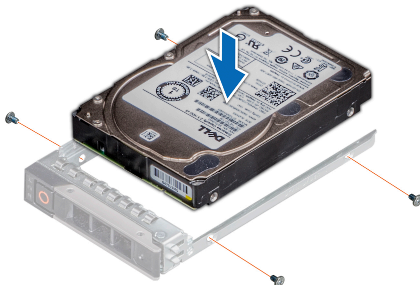
Figure 26. Installation d'un disque dans son support
