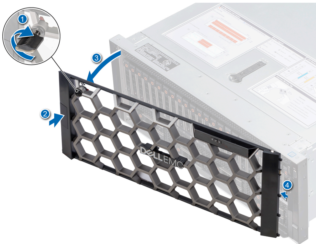
Figure 19. Retrait du cadre avant en option avec l'écran LCD
