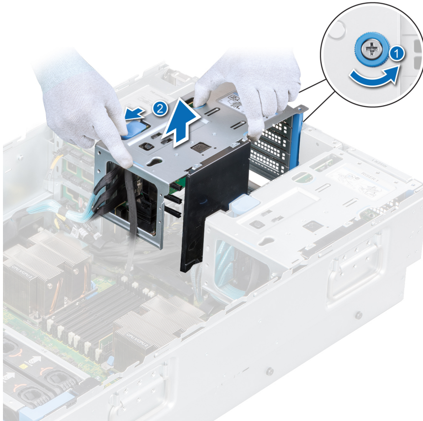
Figure 85. Retrait de la carte de montage PCIe X8 2
