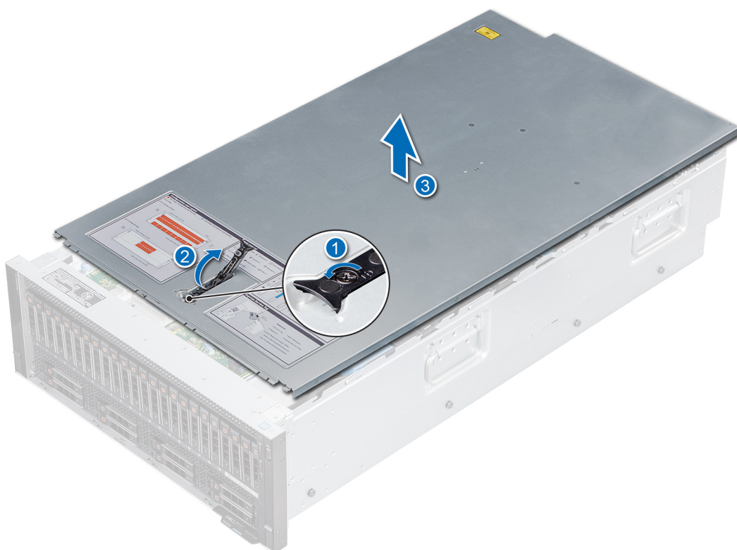
Figure 27. Retrait du capot du système
