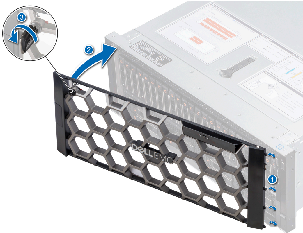
Figure 20. Installation du cadre avant en option avec l'écran LCD
