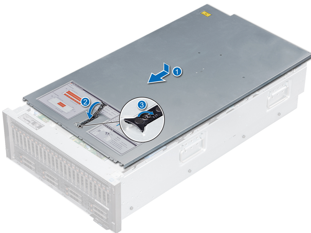
Figure 28. Installation du capot du système
