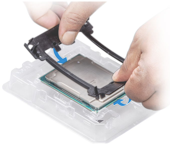
Figure 79. Installation du support de processeur
