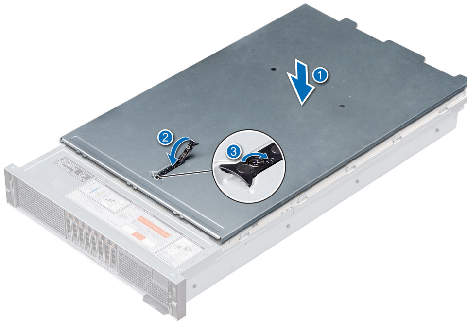
Abbildung 20. Installieren der Systemabdeckung
