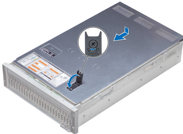
Figura 12. Instalación de la cubierta del sistema
