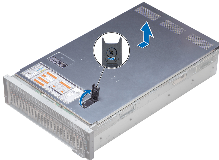
Figura 2. Extracción de la cubierta del sistema
