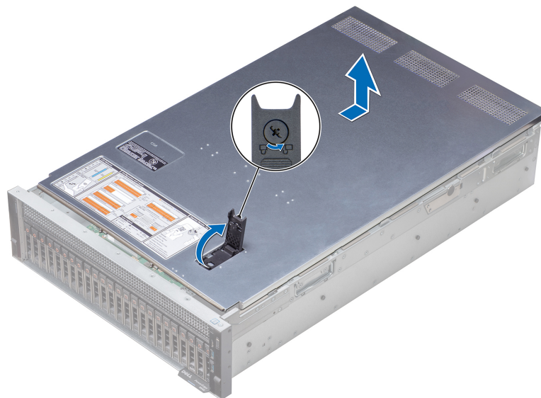
Abbildung 2. Entfernen der Systemabdeckung
